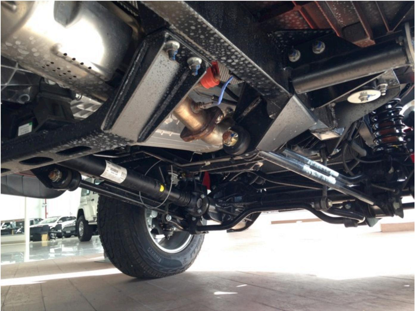
Além disto, pude notar que por causa do ABS a montadora “pendurou” um bocado de chicotes e sensores pela longarina e eixos. Algo que realmente não me preocupa se realizada uma manutenção e limpeza correta de todo o sistema, mas é claro que para os amantes do off-road radical algumas proteções terão que ser desenvolvidas
