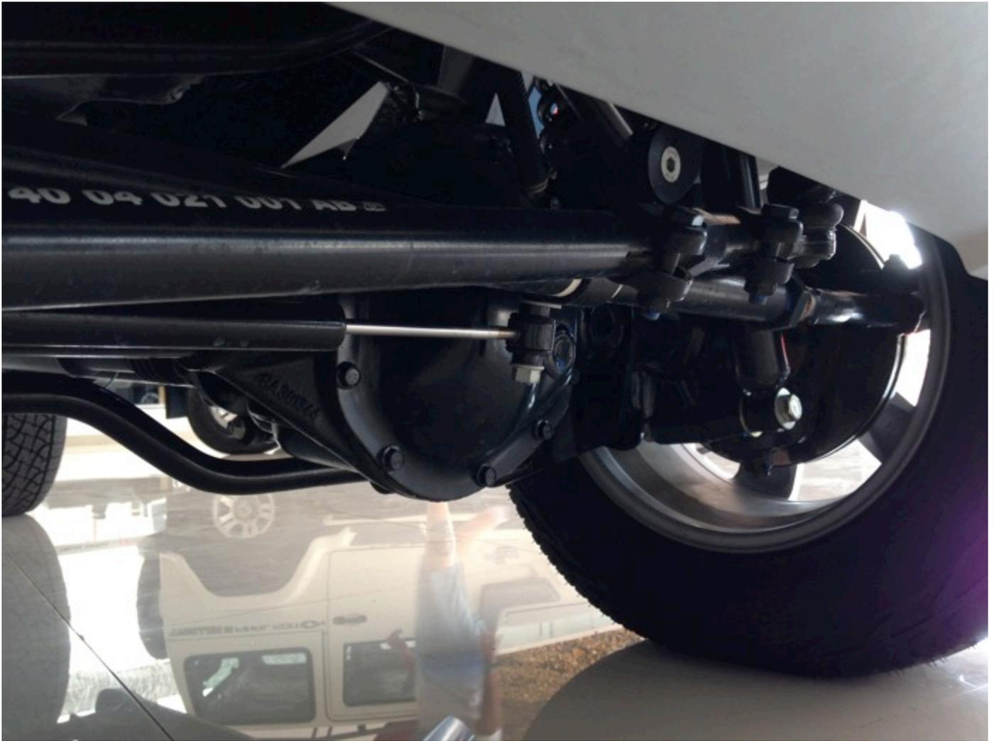
Já a suspensão traseira foi totalmente modificada, com novo eixo, novas fixações das molas e barras estabilizadoras. O que me chamou a atenção foram 02 suportes soldados diretamente no eixo, próximos ao suporte da barra estabilizadora. Dá a impressão de que aquilo era de outro veículo ... e que na trilha vai servir como ancora, já que um está apontado para frente e outro para traz.. muito esquisito.
