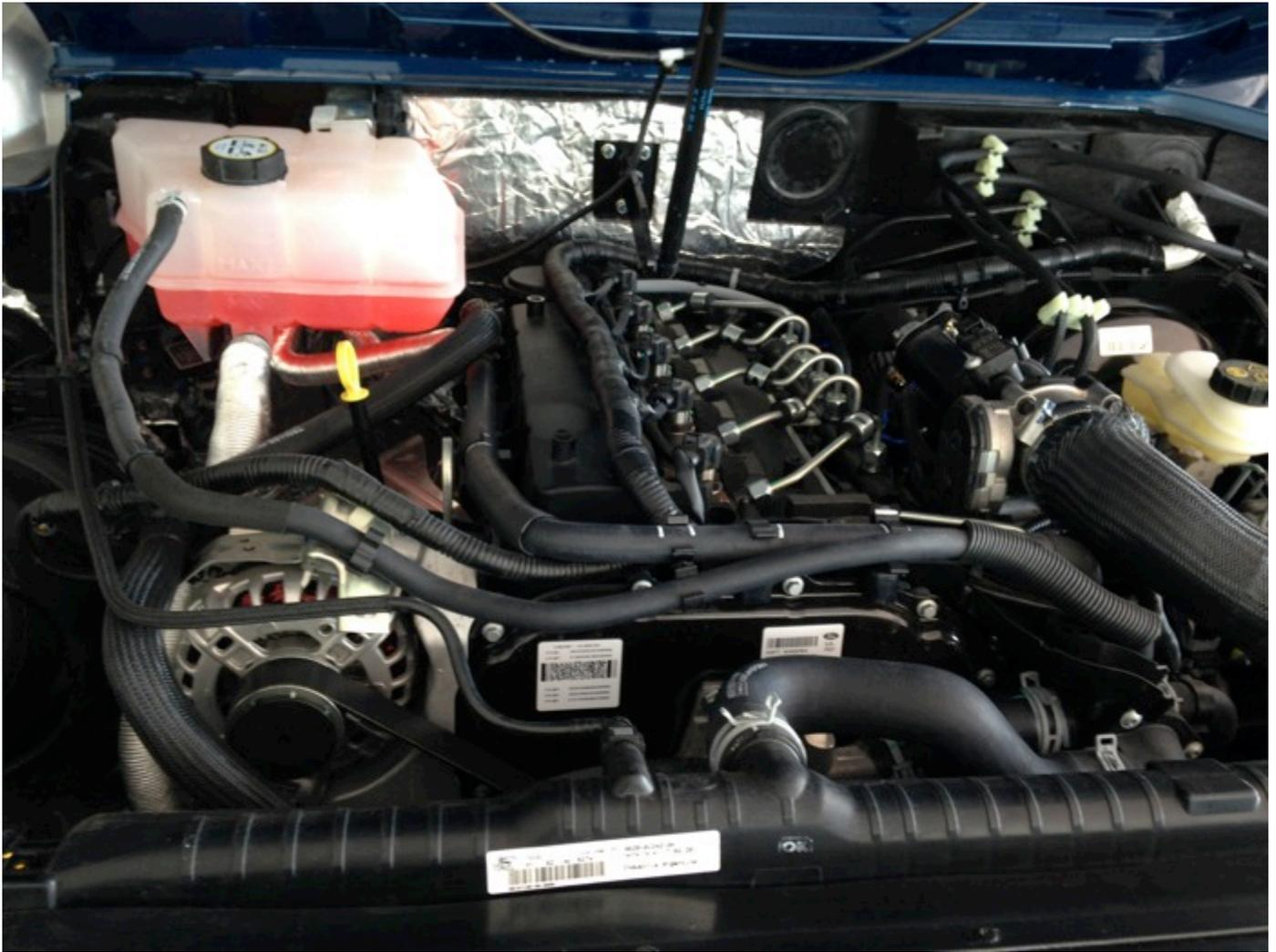
O que me chamou muito a atenção foi a remoção da tampa protetora, deixando os injetores e chicotes expostos. Precisamos ficar muuuito atentos ao acúmulo de poeira na sede dos injetores, afinal não queremos de volta aquele antigo problema de oxidação dos injetores que impossibilitava sua remoção nos motores 3.0, que em muitos casos ocasionado a perda do cabeçote.
