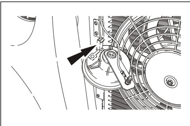
1. Conecte o conector elétrico na buzina e posicione a buzina em seu alojamento.
