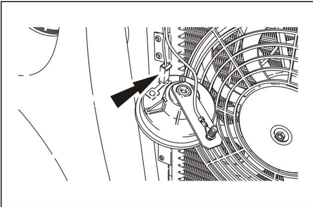
3. Remova a buzina de seu alojamento e desconecte o conector elétrico da buzina.
