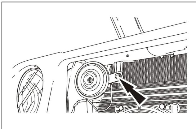
2. Instale o parafuso de fixação da buzina junto com o cabo massa. Aperte o parafuso da buzina com o torque de 23 Nm (17 lbf.pé).
