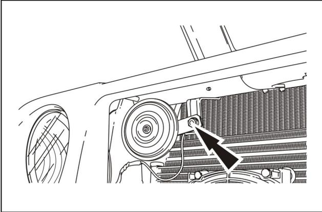
2. Remova o parafuso de fixação da buzina junto com o cabo massa.
