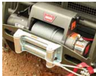
Guincho elétrico montado no pára-choque dianteiro.
