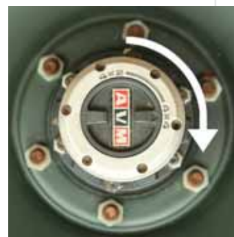
Roda-livre engatada na posição 4x4. Veja a seta indicando o sentido de rotação da chave para o engate. É necessário acionar as duas rodas-livres.
