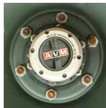
Roda-livre desengatada, permanece na posição 4x2.
