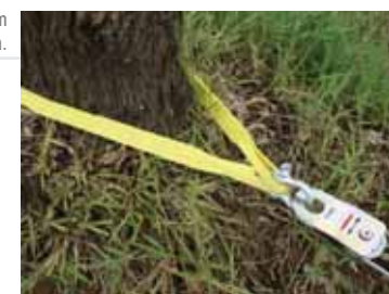
Detalhe da montagem da patesca na cinta.
