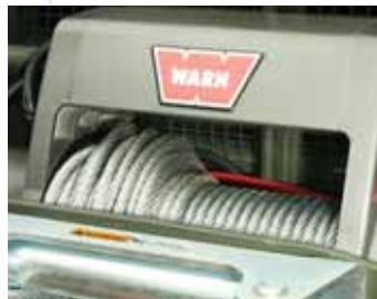
Mantenha distância do guincho ao recolher o cabo de aço.
