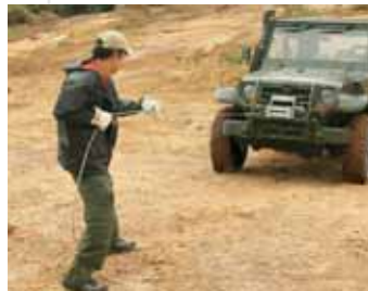
Mantenha distância do guincho ao recolher o cabo de aço.
