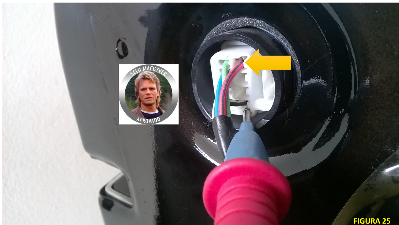
Figura 25: PORTA: Cheque o fio VERMELHO/PRETO com o multímetro e veja se o mesmo recebe um pulso aproximado de 12v quando você ativa as travas da porta. Esse é o fio que será conectado ao módulo na Figura 27.
