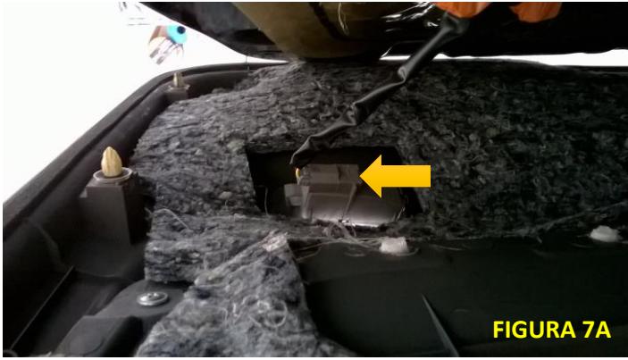
Figura 7A / 7B: Desconecte os conectores antes de separar o forro da porta.
