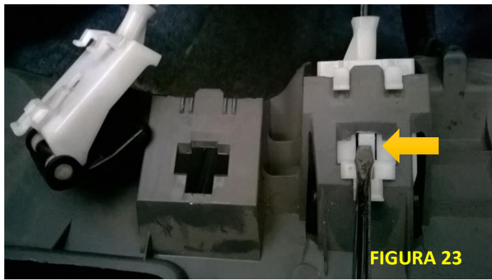
Figura 22/23: Desconecte os cabos de abertura do capô e tanque de combustível usando uma chave fenda, pressionando o conector para baixo e puxando a peça para trás.
