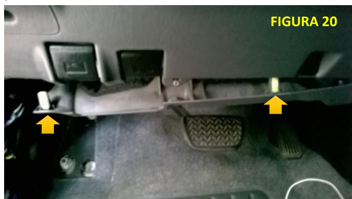
Figura 19/20: Após ter tirado o anel da ignição solte o acabamento plástico, puxando com cuidado para não quebrar.
