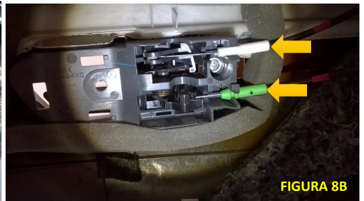
Figura 8A / 8B: Desconecte os cabos de abertura e travas do forro da porta. Basta puxar as peças (branca e verde) com cuidado para não quebrar. Analise visualmente como estão presas antes de puxar.
