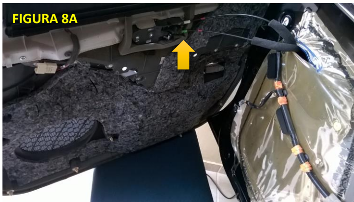
Figura 8A / 8B: Desconecte os cabos de abertura e travas do forro da porta. Basta puxar as peças (branca e verde) com cuidado para não quebrar. Analise visualmente como estão presas antes de puxar.
