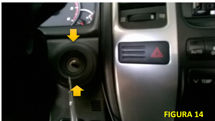
Figura 14: Solte o anel da ignição usando uma chave de fenda, com cuidado para não o arranhar.
