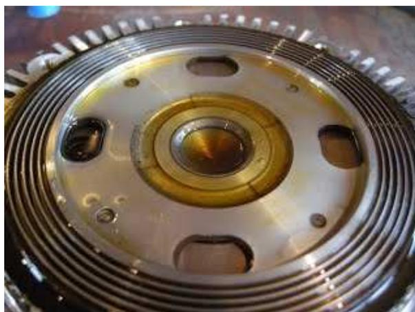
A outra metade tem os parafusos de regulagem da lâmina bi-metálica e as portas por onde passa o óleo.
