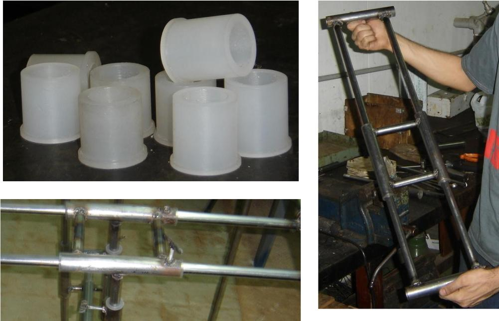
Fig. 23 – No topo à esquerda, as buchas torneadas. À direita os tubos montados. Em baixo, à esquerda, detalhe do parafuso de fixação.
