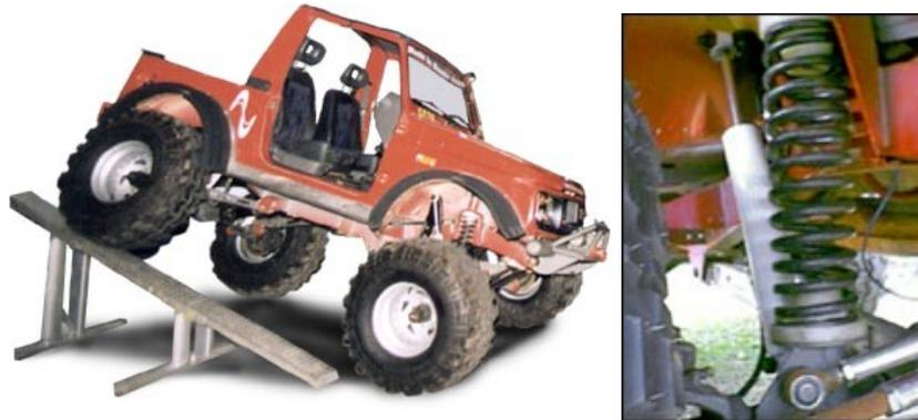
Fig. 20 – Conjunto amortecedor-mola em um veículo *off-road*.
