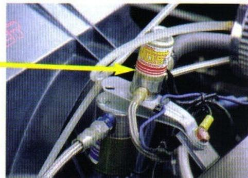
Detalhe da “válvula” do nitro (acima). Reservatório da injeção de água fica ao lado do motor (abaixo)
