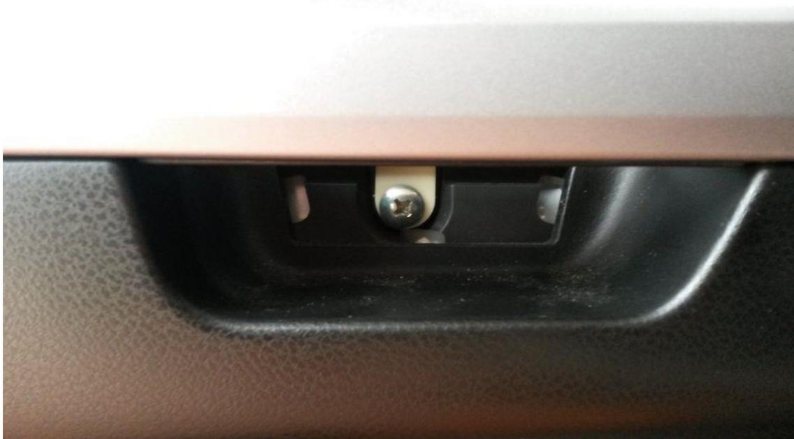
Com a ferramenta apropriada para não arranhar a porta e danificar o forro vá fazendo alavancas para ir desencaixando o forro.
