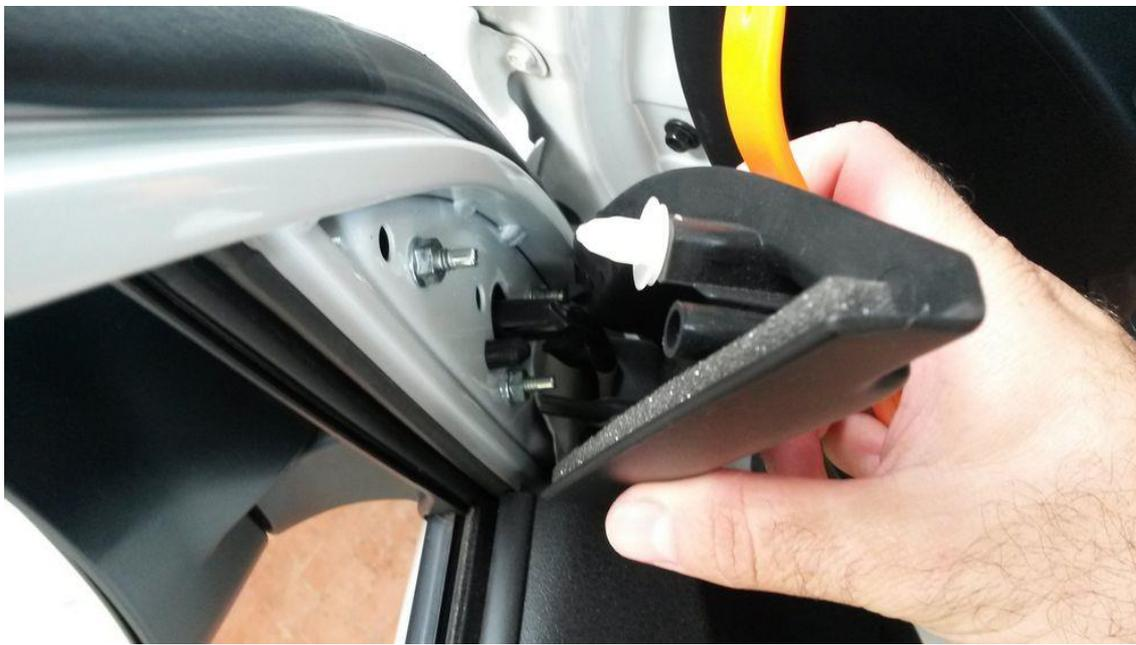
Depois remover a capa do parafuso que tem dentro do puxador, só fazer alavanca para soltar.
