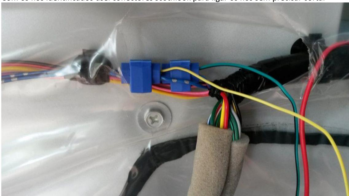
Precisamos de um 12v direto que não tem na porta, então puxe da caixa de fusíveis, a parte mais complicada é essa, a começar para desencaixar a tomada da lataria, solte a proteção de borracha e usando uma chave de fenda fina empurre as travas, são 4 no total, 2 em cima e 2 em baixo, a tomada tem 4 vãos que da passagem para dentro do carro, usei um deles e passei o fio.
