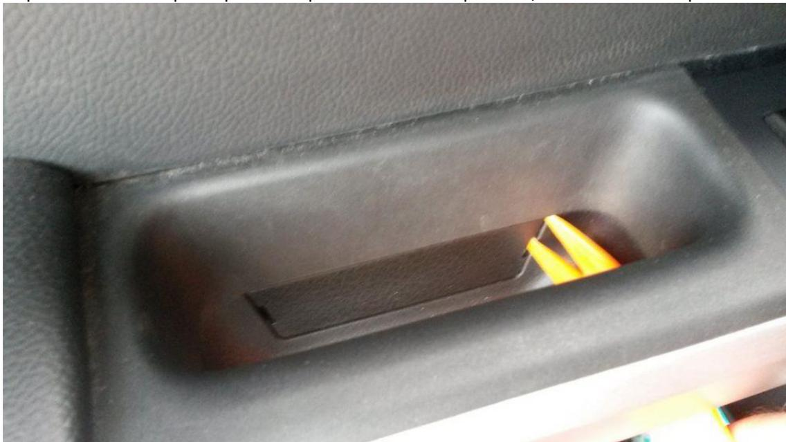
O único parafuso que tem no forro é esse, remova usando uma chave Philips.
