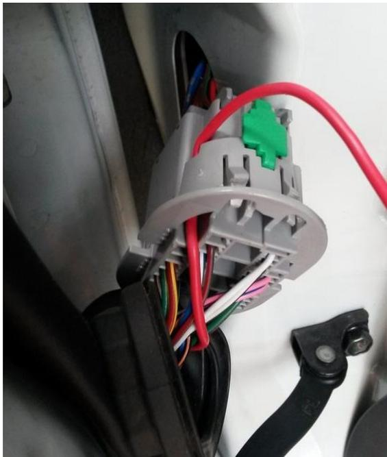
Dentro do carro tem uma borracha de vedação, usei uma chave de fenda fina e furei de dentro para fora, preendi o fio na chave e puxei, passando assim o fio para dentro do carro, como usei uma chave fina o próprio fio faz a vedação na borracha, e ainda assim borracha não fica em área que molha, assim não terá problemas futuros.
