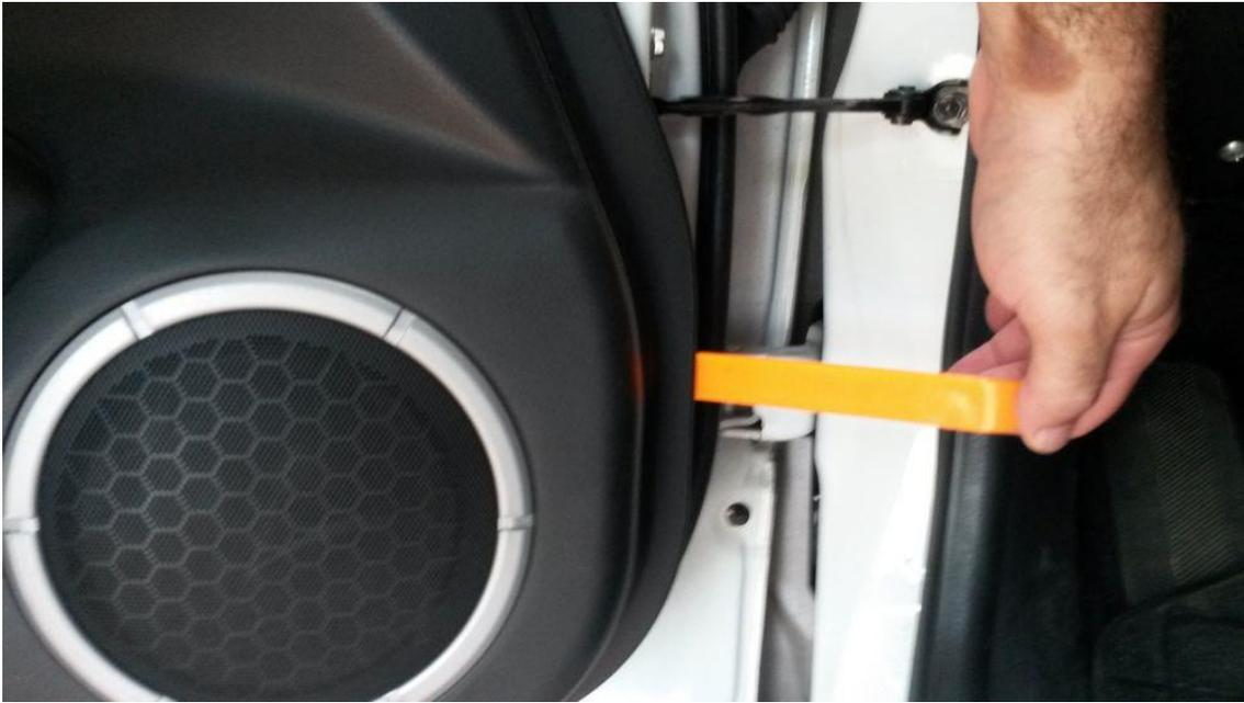
Após desencaixar puxe um pouco para fora e levante para soltar completamente da porta, desencaixe as tomadas do vidro elétrico e retrovisor elétrico e pronto.
