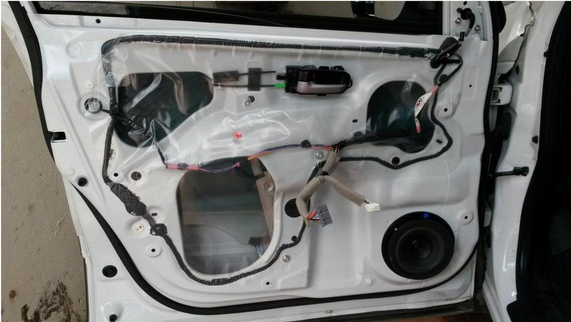
Se quiser instalar o módulo com a função de subida dos vidros pelo alarme e temporização precisa ligar 2 fios que vem soltos no chicote do módulo, um fio é ligado no final de travar e outro fio no sinal de destravar.
