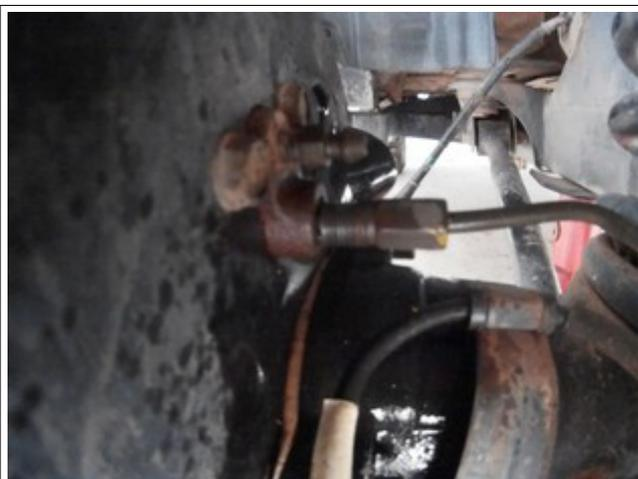
8 Passo: agora você deve remover as quatro porcas que seguram a placa do tambor de freio no eixo. Essas porcas, que no futuro, serão utilizados para fixar o suporte do freio. Observe que quando você retira as porcas a peça que segura o retentor fica “solta”.
