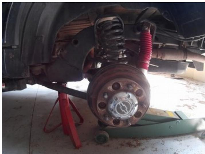
3 Passo: use dois parafusos m10 para rosquear nos furos do tambor para que ele seja removido. Essa operação você deve fazer lentamente e sempre dando umas batidas com um martelo no tambor para que ela vá “descolando” das partes. Aperte os parafusos e bata até que o tambor de freio fique solto, aí você pode retirá-lo com as mãos.
