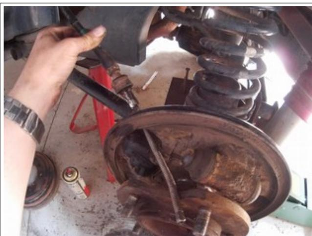
7 Passo: agora você precisa desconectar as tubulações de freio do cilindro, se for a roda direita você deve desconectar duas tubulações, se for a roda esquerda, somente uma.
