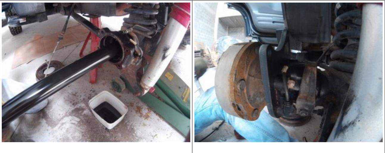
4 Passo: certificando que o rolamento está no encaixe correto e os parafusos do suporte do retentor estão alinhado, bata no cubo até que todo o rolamento entre no encaixe, você pode usar mesmo dispositivo que usou para remover o eixo um pedaço de madeira bem grande e maciço.
