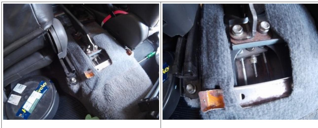
13 Passo: agora observe que existem dois cabos encaixados em um “T” de metal, você deve primeiramente soltar essa porca central para que os cabos fiquem “soltos” você deve soltar até que seja possível girar a peças e puxar o cabo para lateral até ele desencaixar.
