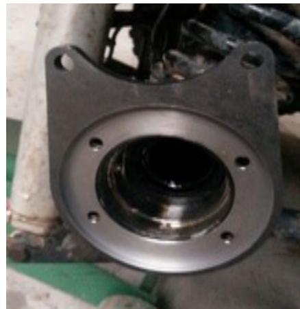
2 Passo: passe cola no suporte do retentor, no local aonde será o contato do suporte da pinça
