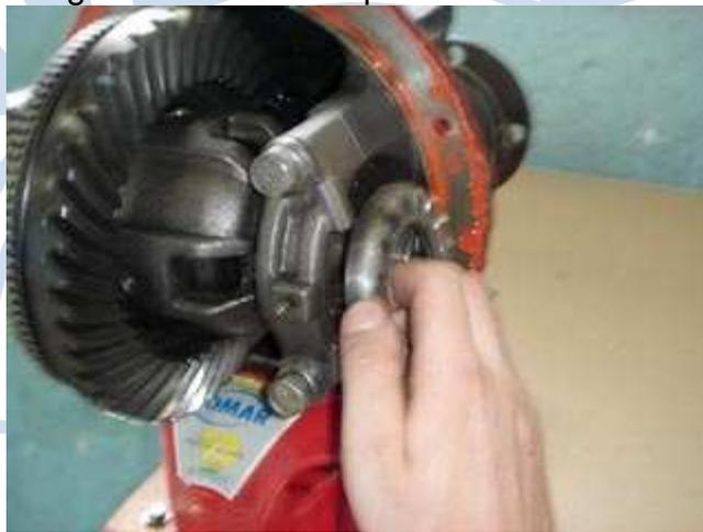
Fig. 06 – Soltando a porca de ajuste da coroa.
