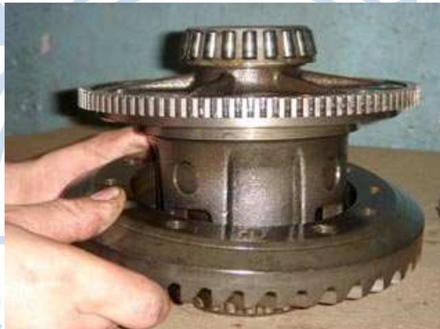
Fig. 09 – Removendo a coroa. Lembre de marcar a posição que ela estava.
