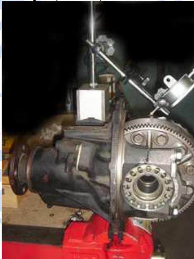
Fig. 01 – Medindo o back lash com um relógio comparador.
