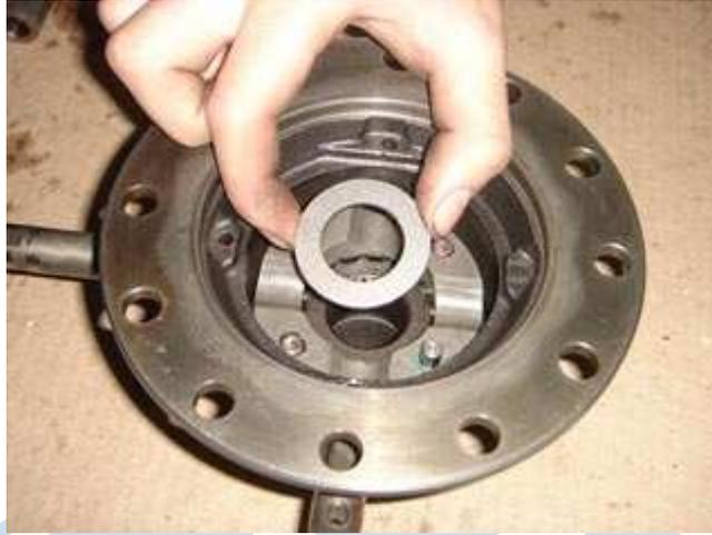
Fig. 16 – Montagem do bloqueio + arruela.
