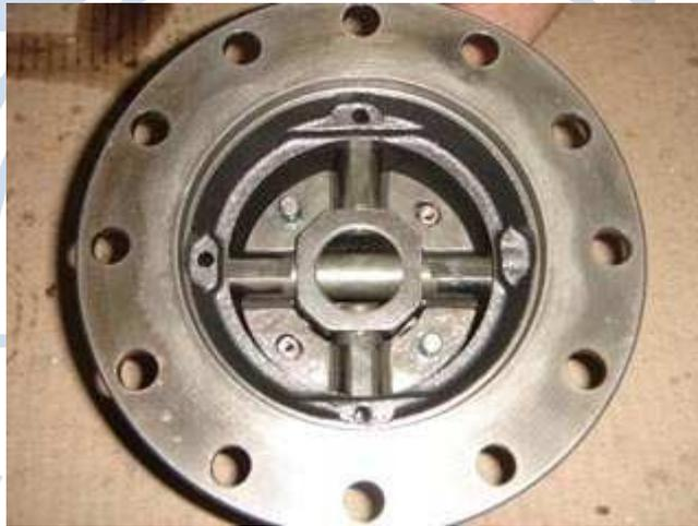
Fig. 17 – Montagem de metade do bloqueio.
