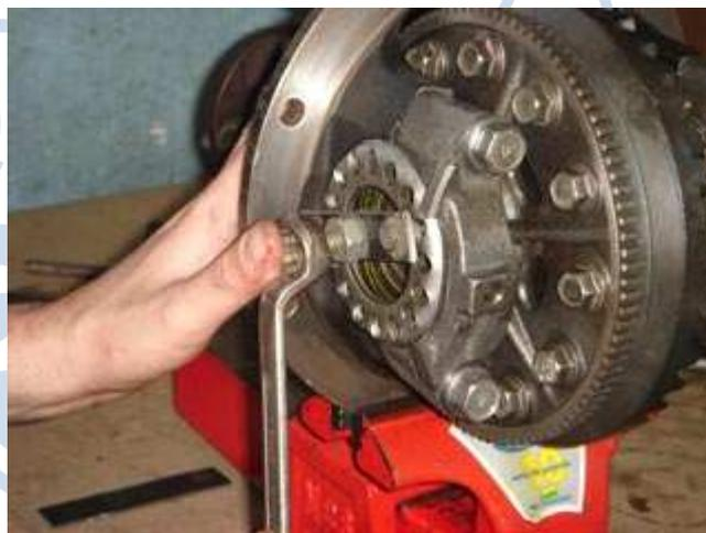
Fig. 22 – Montagem da caixa no diferencial e aperto da porca de ajuste dos rolamentos da coroa.
