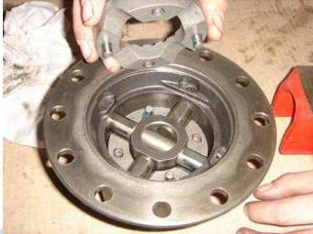
Fig. 18 – Montagem da segunda parte do bloqueio.
