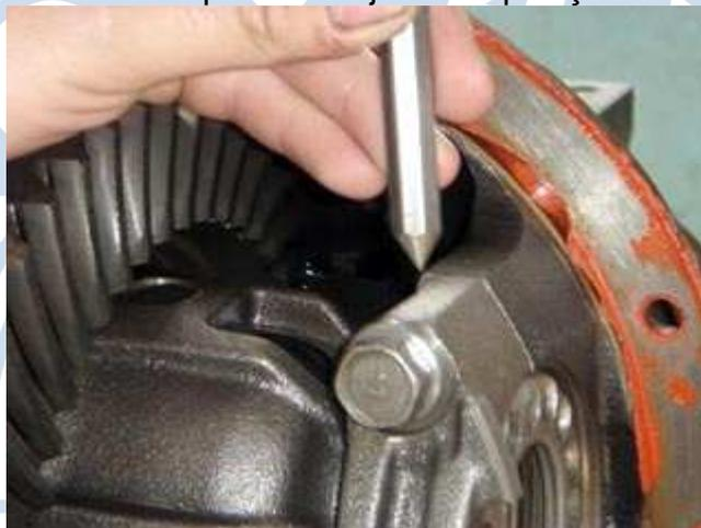
Fig. 03 – Marcando o mancal do rolamento da coroa, para evitar montagem invertida.
