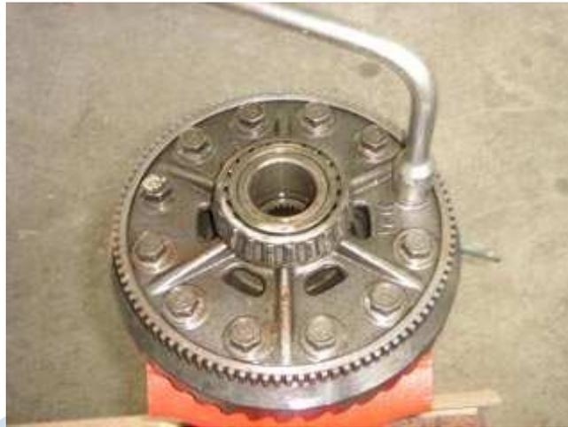
Fig. 08 – Soltando os parafusos da coroa
