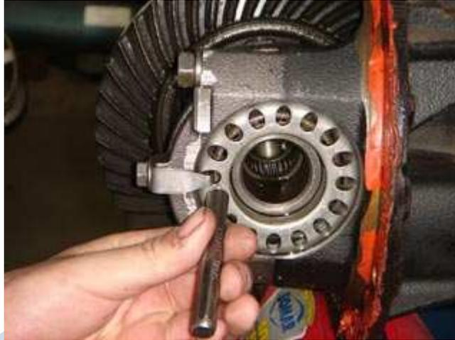
Fig. 02 – Marcando a porca de ajuste na posição de montagem.
