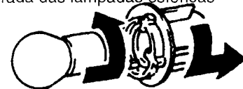
Retirada das lâmpadas esféricas
