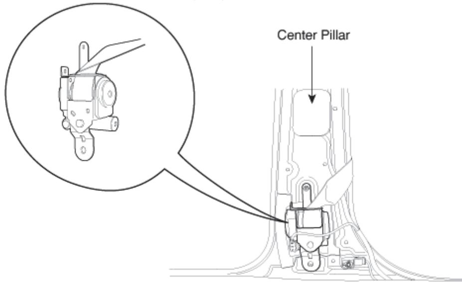
**SUPPLEMENTAL RESTRAINT SYSTEM CONTROL MODULE (SRSCM)**
