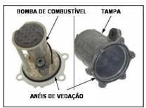
13. Fixe cuidadosamente a tampa da bomba de combustível na morsa e, em seguida, instale a unidade da bomba de combustível dentro da tampa <u>alinhando corretamente as guias</u>, conforme figura ao lado.
