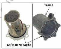
Para remover o filtro de combustível, segure-o por cima e desacople o gancho do filtro da guia do corpo da bomba girando o filtro no sentido horário.
