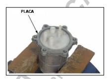
15. Instale as arruelas de pressão e os parafusos, conforme figura ao lado.
