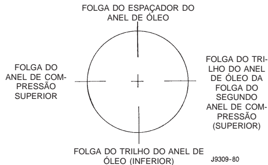
Fig. 50 Instalação Adequada do Anel
