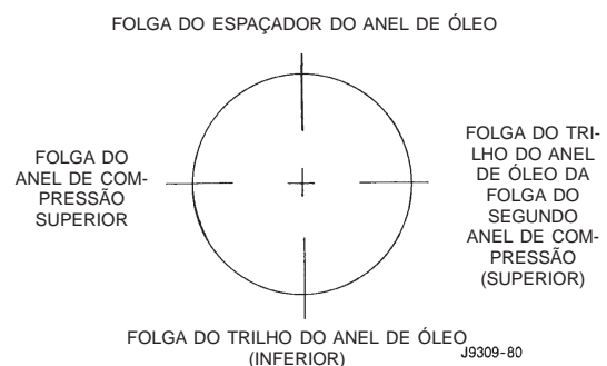
Fig. 50 Instalação Adequada do Anel
