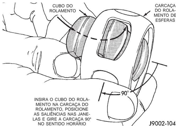
**Fig. 18 Instalação do Cubo do Rolamento**
