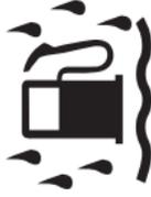
O APARECE EL MENSAJE "WATER IN FUEL", INDICA QUE SE HA DETECTADO AGUA EN EL COMBUSTIBLE POR LO QUE USTED DEBE PROCEDER A DRENAR EL FILTRO SEPARADOR DE COMBUSTIBLE/AGUA.
