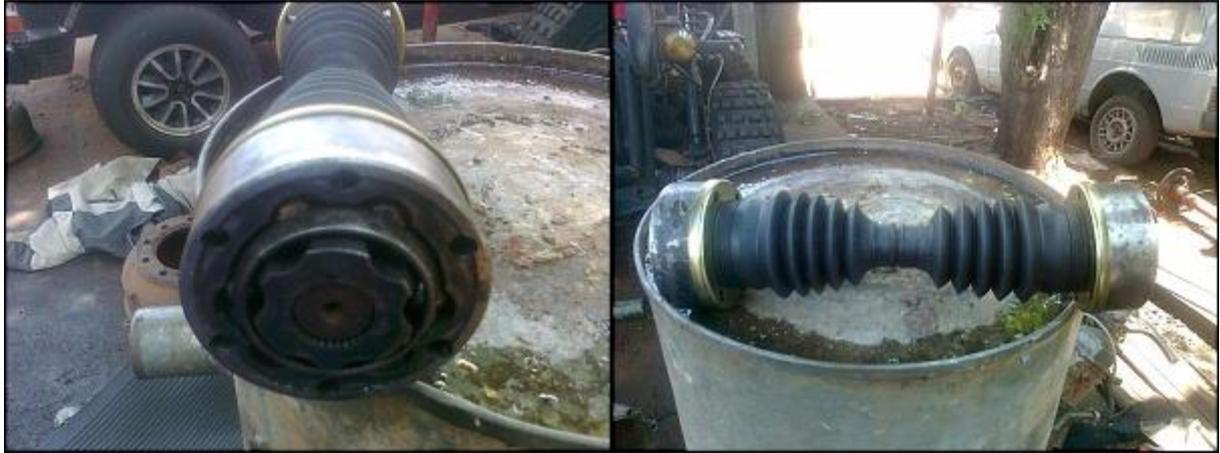
Eixo montado e pronto para instalação
