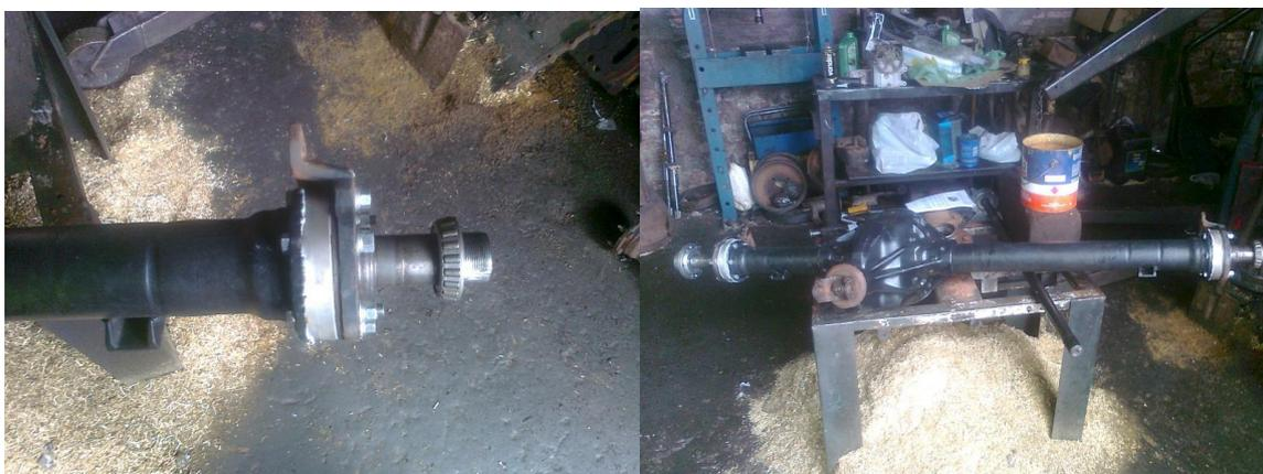
Eixo da Rural com sistema flutuante e adaptação para Javali
