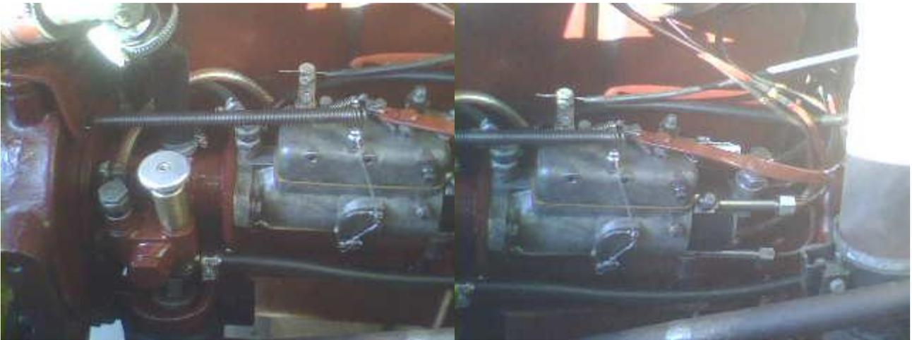
Bomba Cav instalada com suporte adaptador
