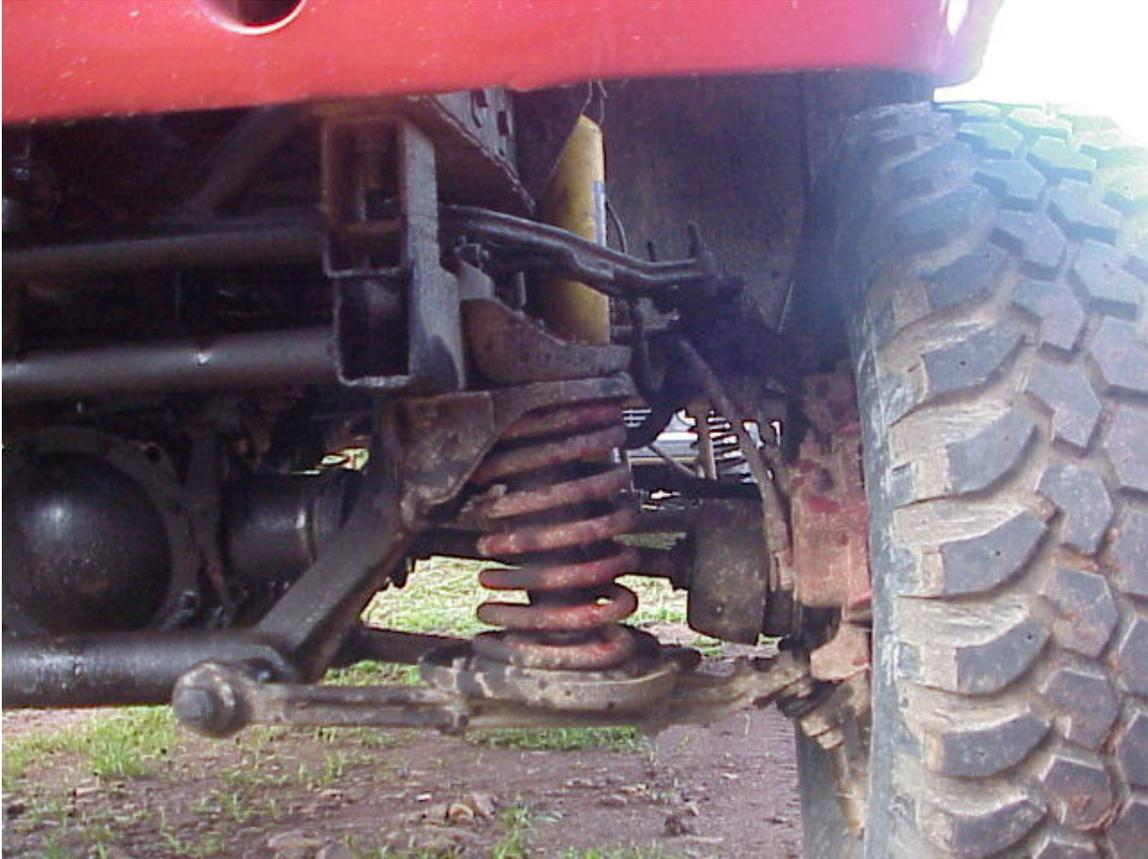
Aparte de esto, se le han colocado amortiguadores de mayor recorrido y de mayor resistencia debido a que la altura que tiene ahora, hay que compensar el nuevo punto de gravedad.
