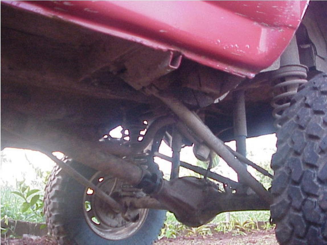
Para lograr esta altura, la suspensión trasera sufre muchos cambios, los cuales son alargamiento de los brazos de tracción (traction bars) y de la barra panhard, aparte de darle inclinación al diferencial, la ubicación de los amortiguadores, espirales mas largas, colocar en nueva posición los platos de base de las espirales en el housing (viga) del diferencial.
