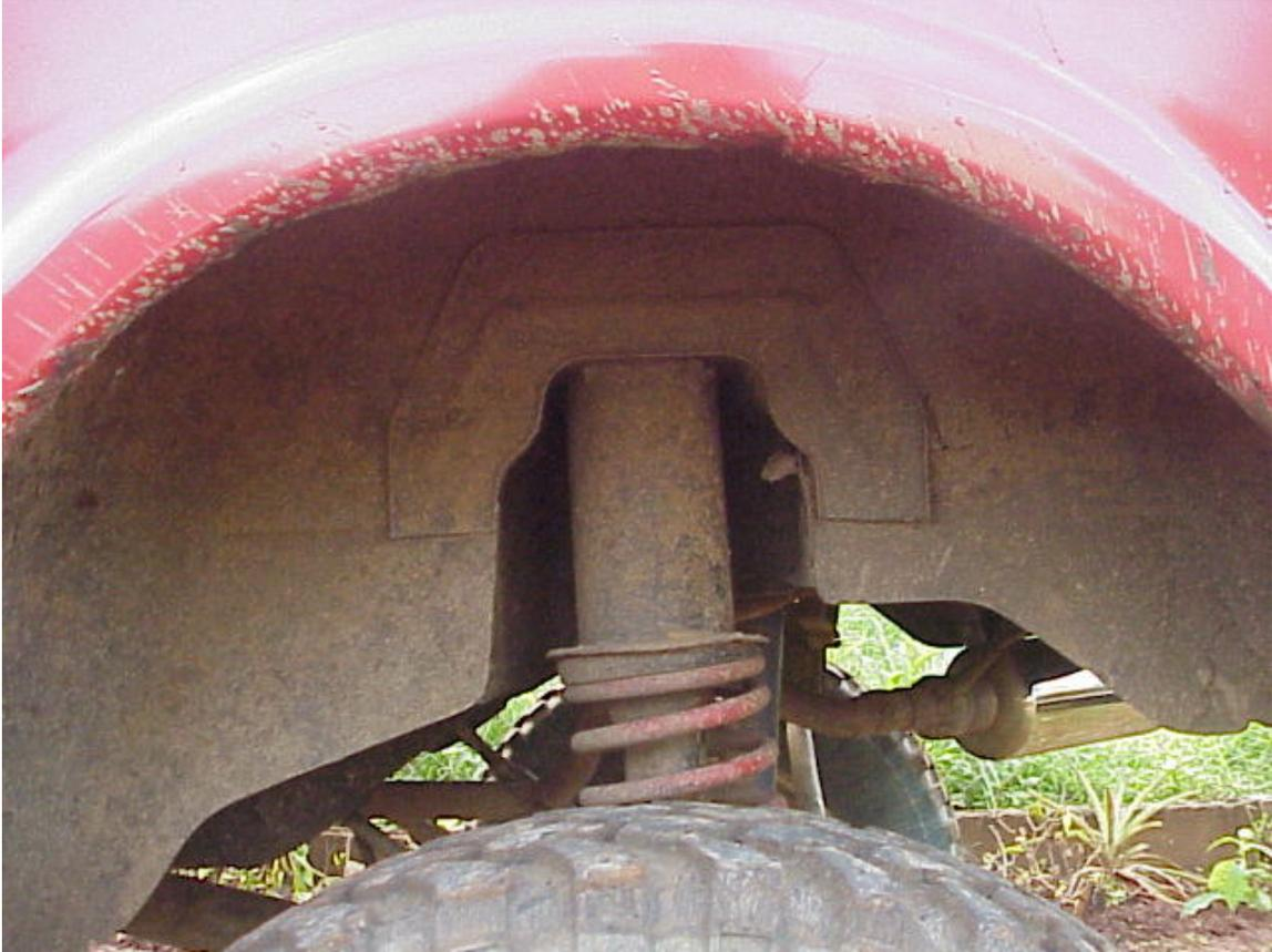
Se le deben colocar calzas (suplementos) a la carrocería para apoyar las espirales para lograr compenazar un nivel con la alzada delantera y la trasera. En este caso se le hicieron 2 piezas las cuales se notan el largo desde el tope (arriba) y abajo.
