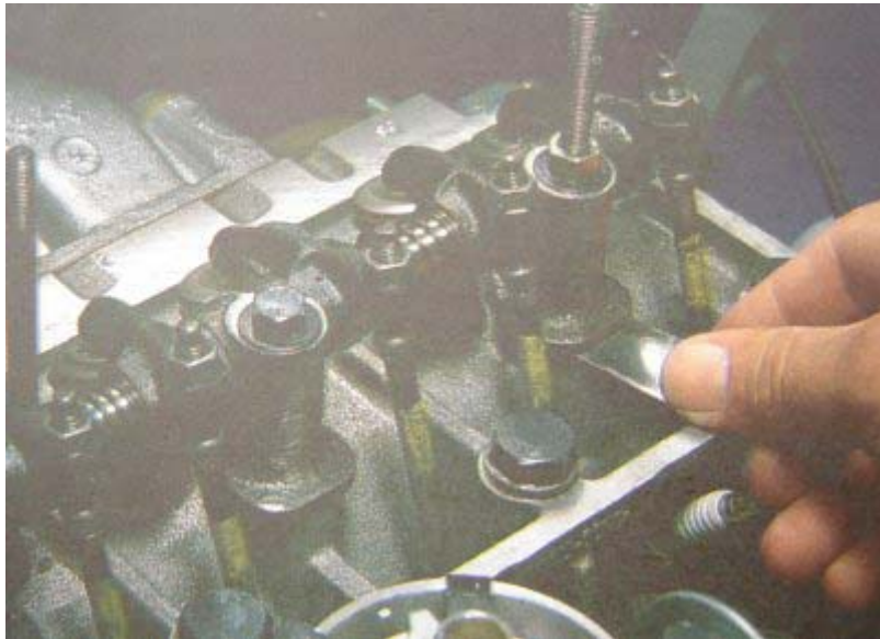
Usando um calço para interromper o fluxo de óleo as válvulas.
