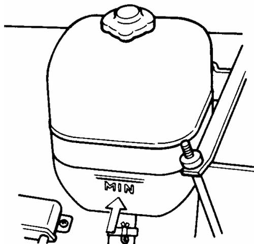
**Fig. 38.** Tanque de expansión del sistema de refrigeración
