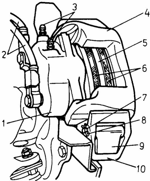
**Fig. 59.** Freno delantero: 1 - bloque de cilindros; 2- mangueras flexibles; 3- racores; 4- soporte; 5- disco de freno; 6- zapatas (pastillas) de freno; 7- eje de la palanca de presión; 8- pasador hendido; 9- guía de las pastillas; 10- palanca de presión
