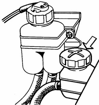
**Fig. 44.** Tanque del hidroaccionamiento del desembrague
