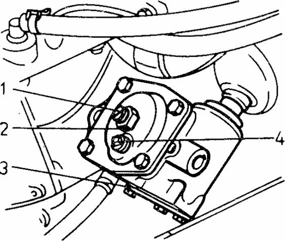
**Cada 60.000 km de recorrido** compruebe el nivel del aceite en el cárter del mecanismo de la dirección. El nivel del aceite debe estar en el borde inferior del agujero de control que se cierra con el tapón 4.
