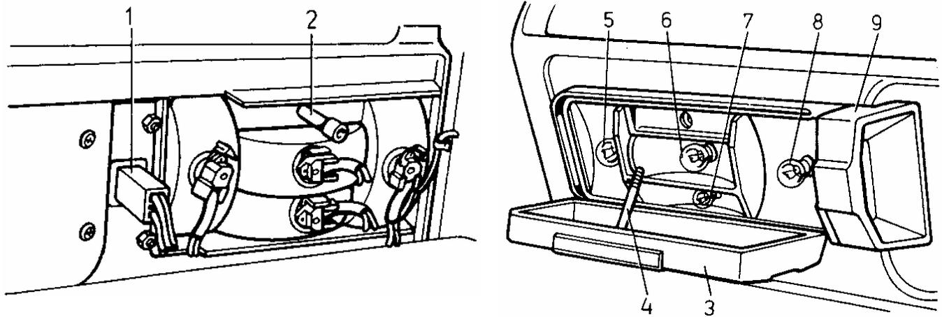
**Fig. 69.** Linterna trasera y linterna para alumbrar la matrícula: 1 - empalme; 2 tuerca; 3- dispersor; 4- espárrago; 5 lámpara del indicador de dirección; 6- lámpara de la luz de marcha hacia atrás; 7- lámpara de la luz de contorno; 8- lámpara de la luz de "pare"; 9- linterna de alumbrado de la matrícula
