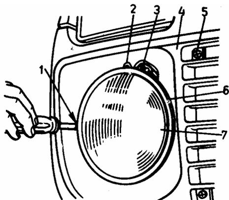
**Fig. 68.** Faro: 1 - tornillo de regulación del haz luminoso en dirección horizontal; 2 tornillo de regulación del haz luminoso en dirección vertical; 3- tornillo de sujeción del aro del faro; 4- revestimiento decorativo del radiador; 5- tornillo de sujeción del revestimiento decorativo; 6- aro del faro; 7- elemento óptico
