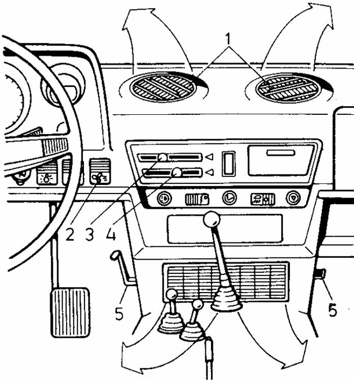
**Fig. 9.** Órganos de mando de la calefacción: 1 - deflectores giratorios; 2- conmutador de tres posiciones del electroventilador del calefactor; 3- palanca de mando de la llave del calefactor; 4- palanca de mando de la tapa de la escotilla del paso de aire; 5- palancas de la tapa del calefactor.
