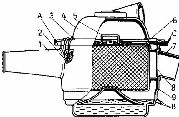
**Fig. 77.** Depurador complementario de aire: 1 - tubuladura para tomar el aire frío; 2- palanca; 3- presilla; 4- tapa; 5 grapa; 6- elemento filtrante; 7- tubuladura para tomar el aire caliente; 8 - deflector; 9- cuerpo; A, B y C - marcas
