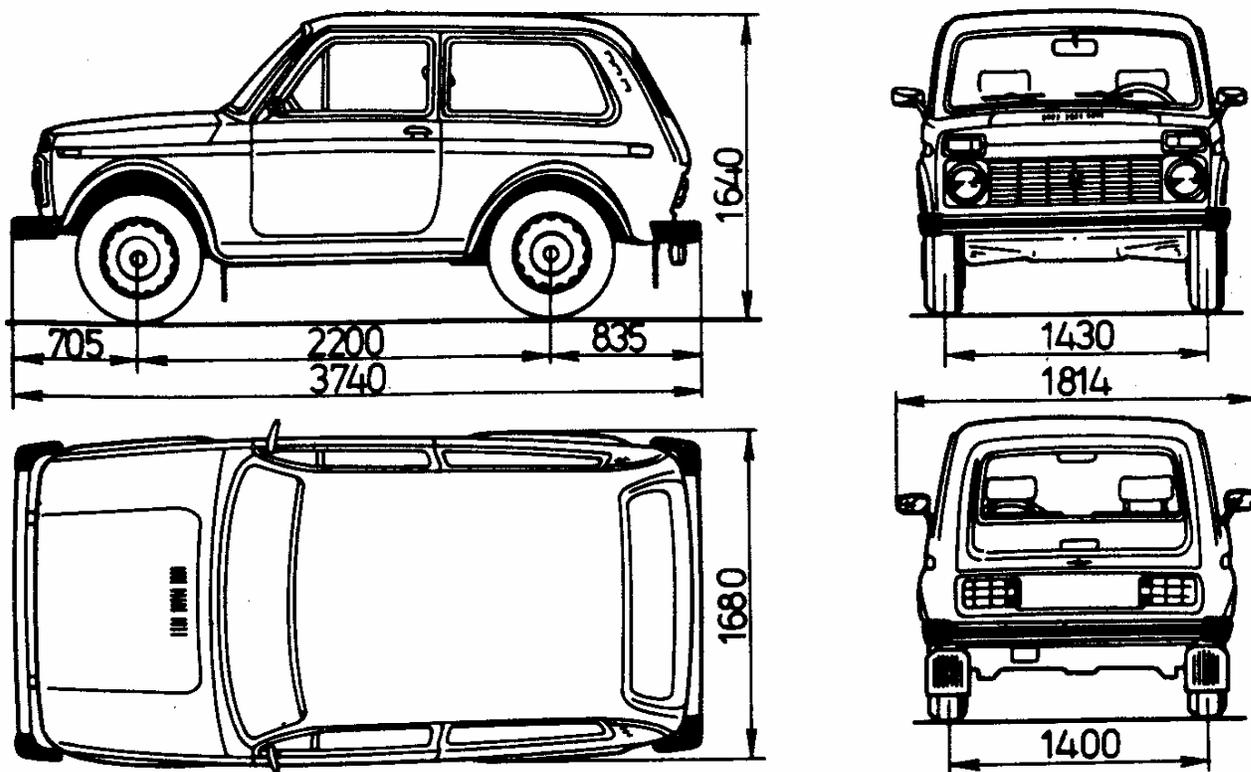
Fig. 2. Dimensiones exteriores
