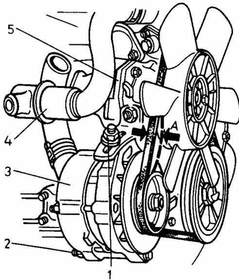
**Fig. 40.** Verificación del tensado de la correa de accionamiento del generador (alternador): 1 - tuerca; 2- tuerca del perno de la sujeción a charnela del alternador; 3- alternador; 4- termostato; 5- bomba de agua; A - combado de la correa
