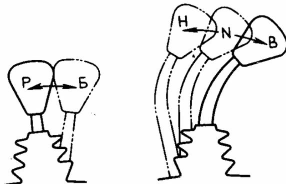
**Fig. 20.** Palancas de la caja de reenvío: Posiciones de la palanca de bloqueo del diferencial. P -desbloqueado; Б- bloqueado. Posiciones de la palanca de cambio de velocidades: H- marcha inferior; N posición neutra; B - marcha superior
