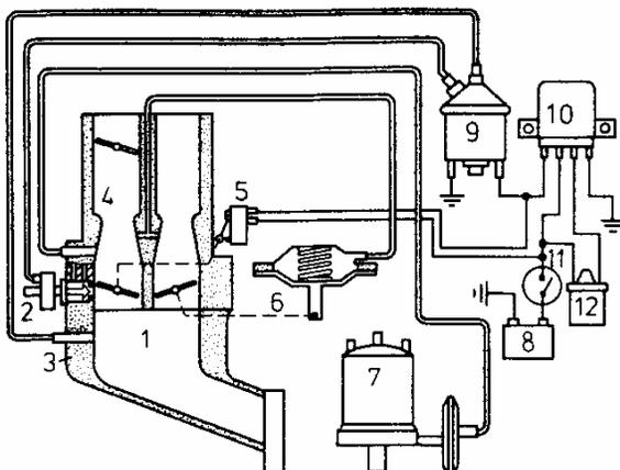
**Fig. 81.** Esquema del sistema de reducción de la toxicidad de los gases quemados con válvula electroneumática: 1 - tubo de admisión; 2- economizador de ralentí forzado; 3 - sistema autónomo del ralentí; 4- carburador; 5 - microconmutador; 6- accionamiento neumático de la mariposa
