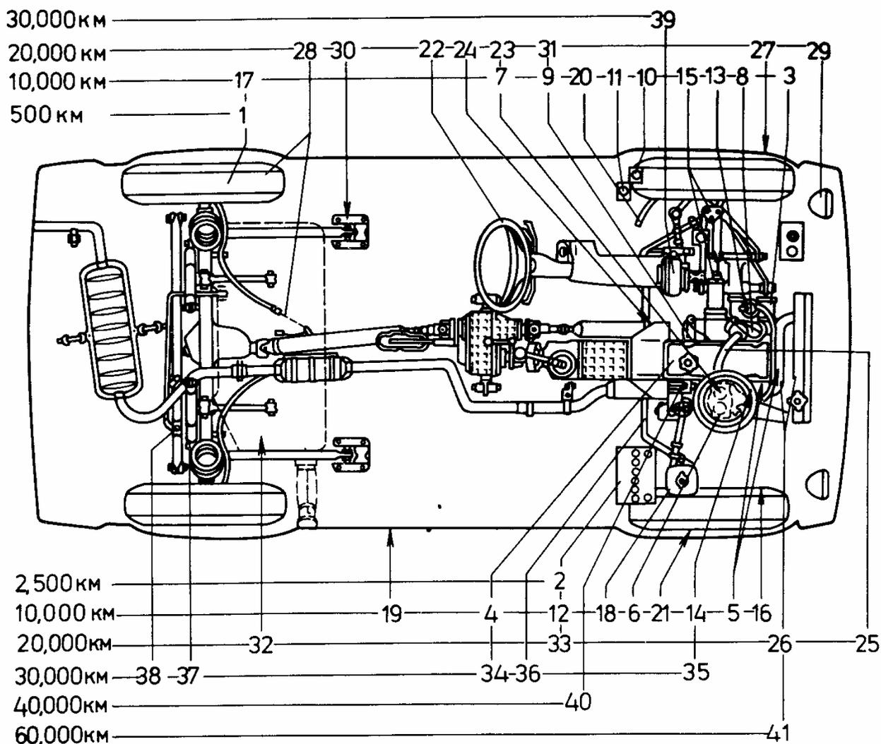
Fig. 26. Esquema de limpieza, verificación y regulación
