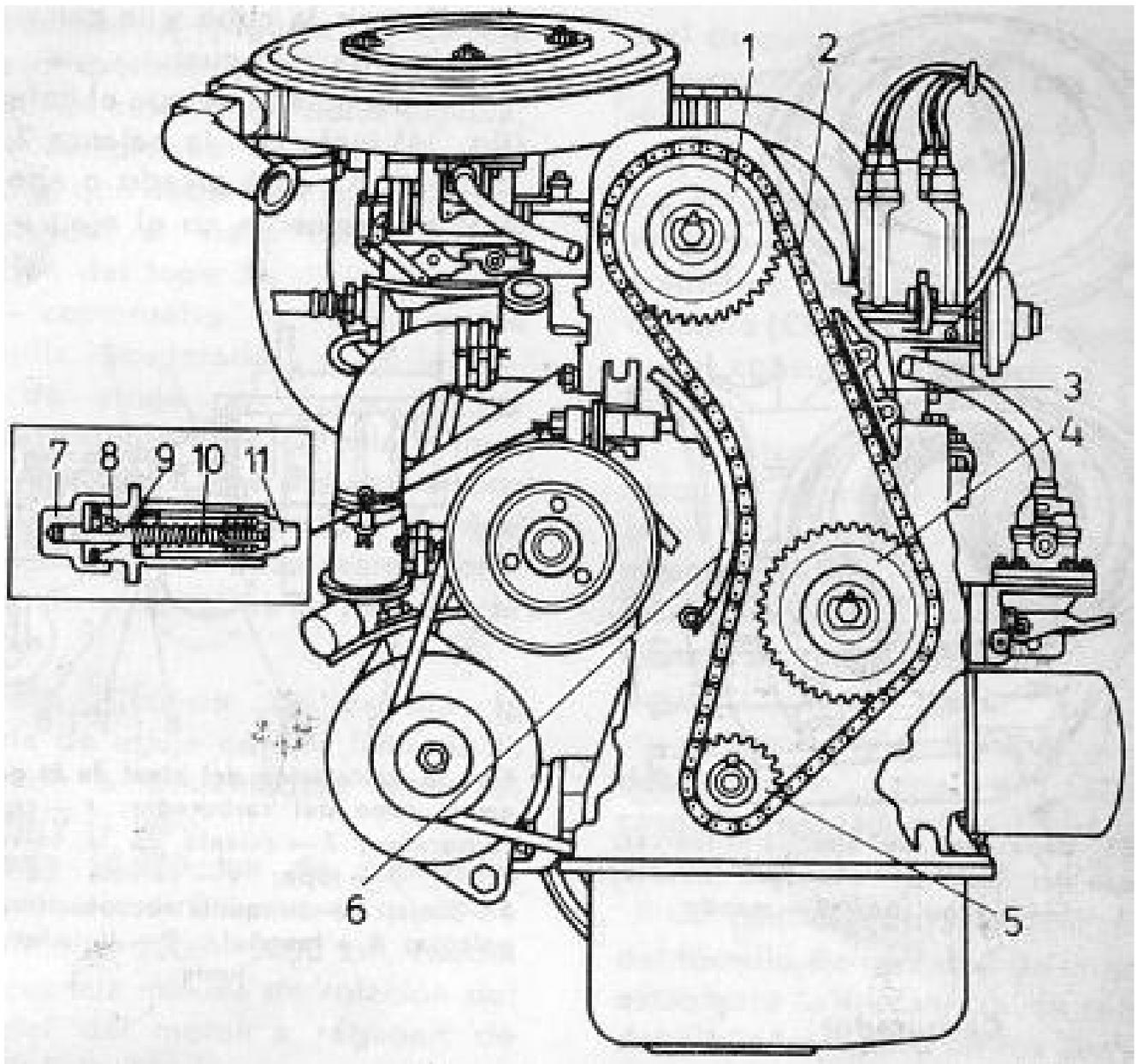
**Fig. 34.** Esquema de accionamiento del mecanismo de la distribución: 1 - estrella del árbol de levas; 2 - cadena; 3 - apaciguador; 4 - estrella del eje de accionamiento de la bomba de aceite; 5 - estrella del cigüeñal; 6 - zapata del tensor de la cadena; 7 - tuerca fijadora de la varilla del
