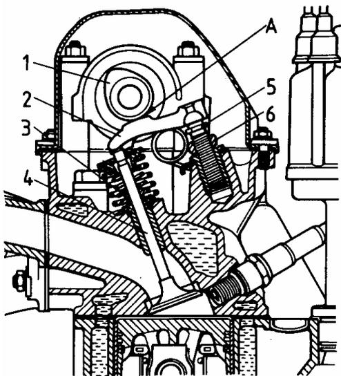
**Fig. 29,** Mecanismo de la distribución: A - holgura entre la palanca y la leva; 1 - leva del árbol de levas; 2 - palanca de accionamiento de la válvula; 3 - capacete reflector de aceite de la válvula; 4 - válvula; 5 - tornillo de regulación de la palanca; 6 - contratuerca del tornillo de regulación.
