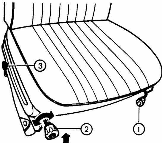
**Fig. 13.** Asiento delantero: 1 - manija de bloqueo; 2- palanca para regular la inclinación del respaldo; 3- manija
