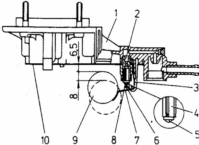
**Fig. 36.** Instalación del nivel de la gasolina en la cuba del carburador: t - tapa del carburador; 2- asiento de la válvula de aguja; 3 - tope; 4 - válvula de aguja; 5- bola; 6- horquilla recuperadora; 7 palanca; 8- lengüeta; 9- flotador; 10 - junta
