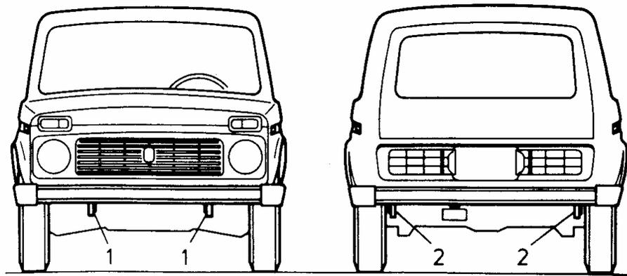
**Fig. 24.** Orejetas para remolcar el automóvil:
