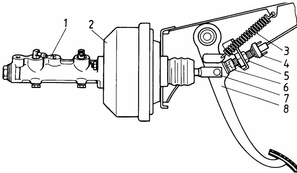
**Fig. 63.** Accionamiento de los frenos de trabajo: 1 - cilindro principal del hidrosistema de los frenos; 2- servo a vacío; 3- muelle recuperador del pedal; 4- interruptor de la luz de "pare"; 5 - tuerca del tornillo de apoyo; 6- tope del interruptor de la luz de "pare"; 7- empujador; 8- pedal del freno
