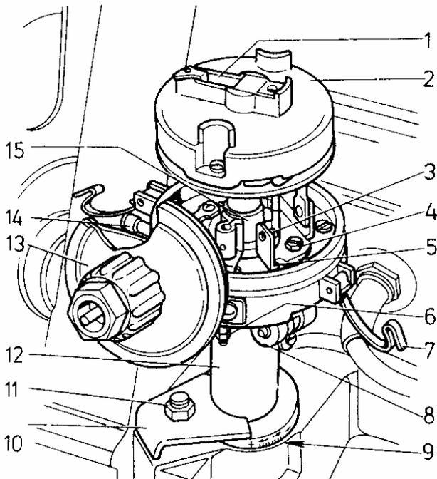
**Fig. 41.** Distribuidor del encendido: 1 - resistencia antiparasitaria; 2 - dedo; 3 - contactos del ruptor; 4 - tornillo; 5 - ranura; 6 - borne; 7 - presilla; 8 - condensador; 9 - escala; 10 - soporte; 11 - tuerca; 12 - cuerpo; 13 - corrector a vacío; 14 - engrasador; 15 - leva.
