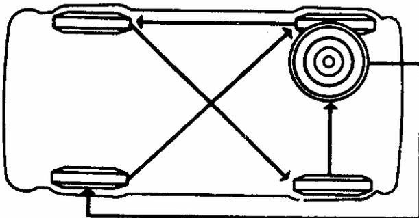
**Fig. 52**, Esquema de permutación de las ruedas
