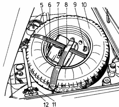
**Fig. 54.** Colocación y sujeción de las herramientas y accesorios: 1, 6, 8, 11 - correas elásticas; 2- gato; 3- manivela de arranque; 4- desmontables de los neumáticos; 5- lámpara portátil; 7- bolsa para las herramientas; 9- tuerca de mariposa; 10- rueda de repuesto; 12 - bomba
