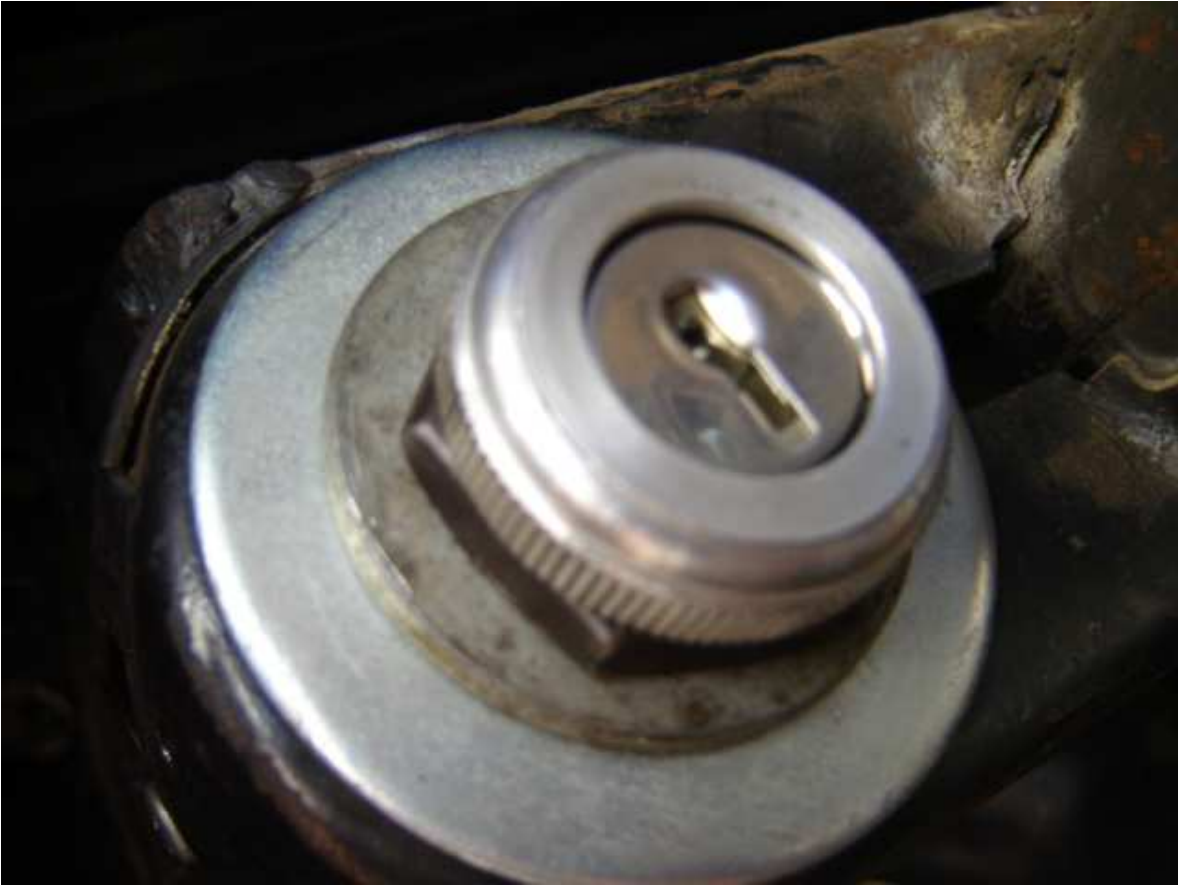
fig. 5 detalhe do interruptor já instalado, apenas um detalhe a arruela menor acabei retirando ficou melhor acabado.
