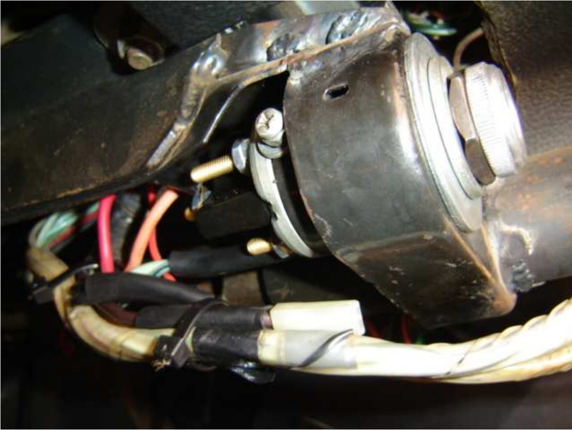
fig. 4 colocado sem maiores adaptações o diâmetro do interruptor encaixa certo no suporte original.
