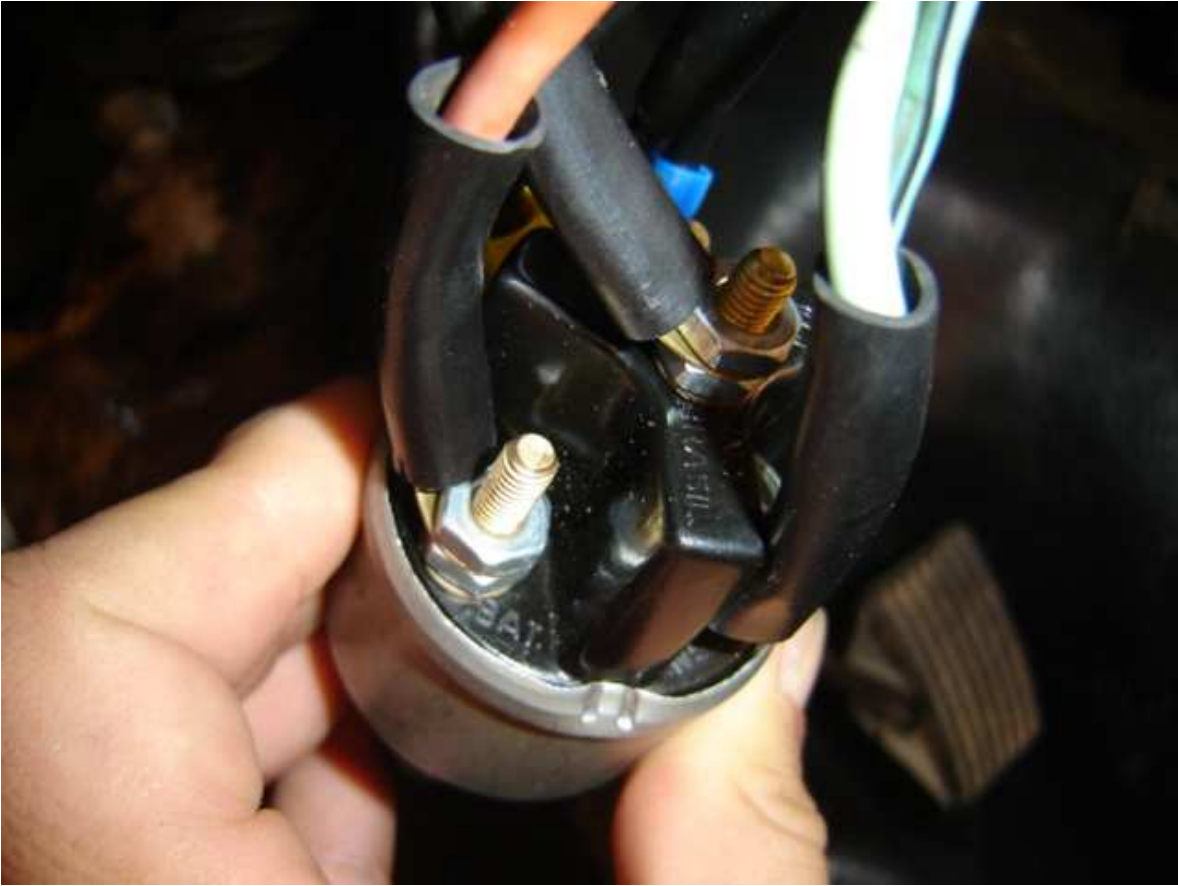
fig.2 traseira do interruptor de ignição as conexões com terminal tipo anel ligados
