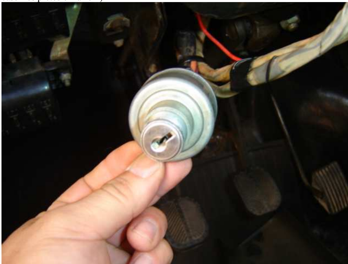
fig.1 interruptor de ignição
