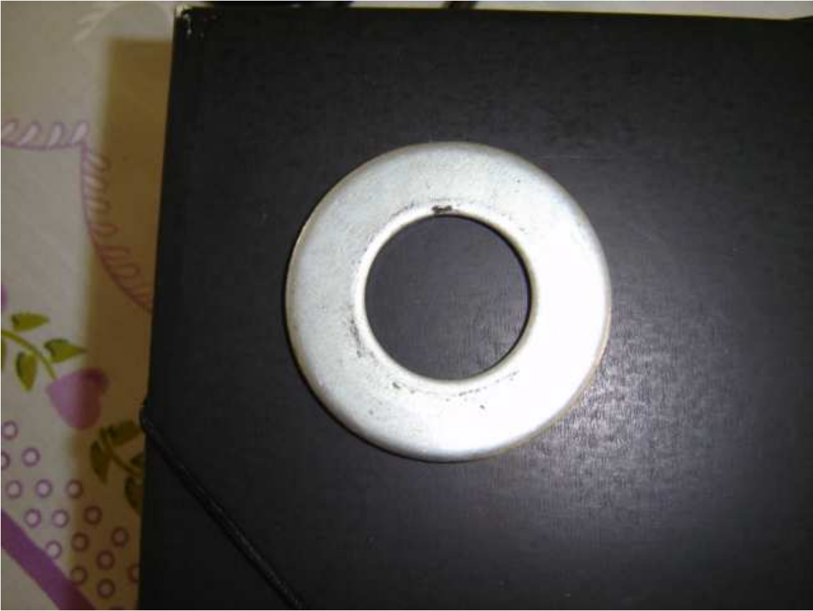
fig.6 As dimensões desta arruela é diâmetro menor 27mm e diâmetro maior 52mm
