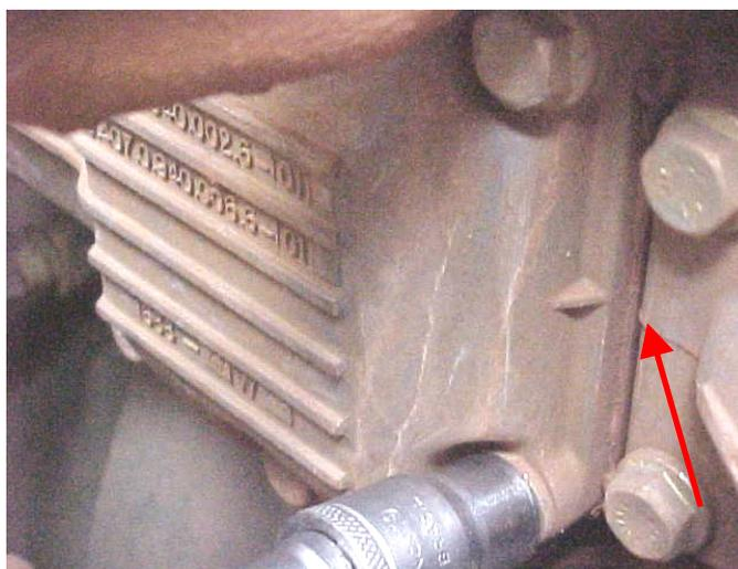
8. Montar o novo resfriador de óleo com a nova junta, atentando-se para a devida limpeza da face de assentamento da mesma no bloco.
