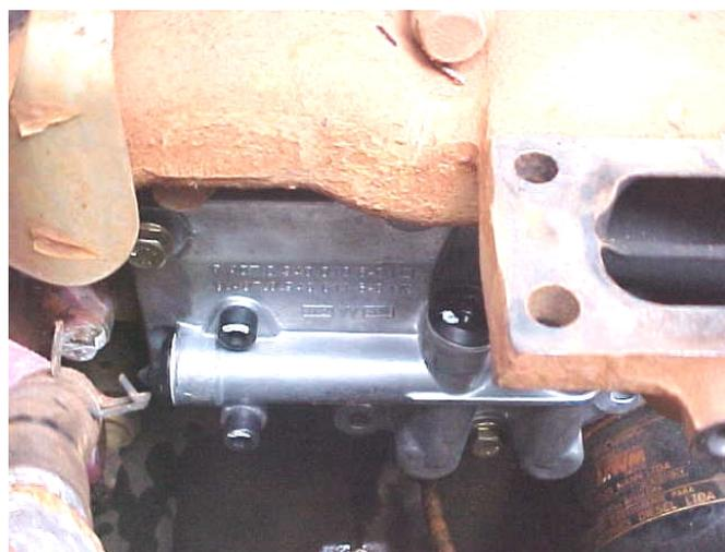
10. Montar o turbocompressor, atentando-se para a devida limpeza da região de assentamento no coletor de escape.
