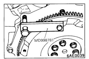
3. INSTALLATION OF DRIVE PLATE <A/T>/1. FLY-WHEEL ASSEMBLY <M/T>
