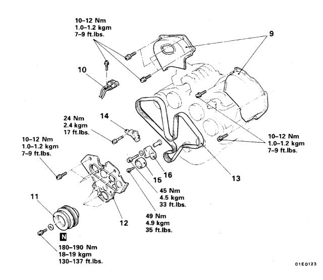
9. Timing belt upper cover 10. Crankshaft position sensor connector 10a! Crankshaft pulley bolt – Заменяйте его на новый при каждом снятии!!! (Информационное письмо ИР-01-003Т)
