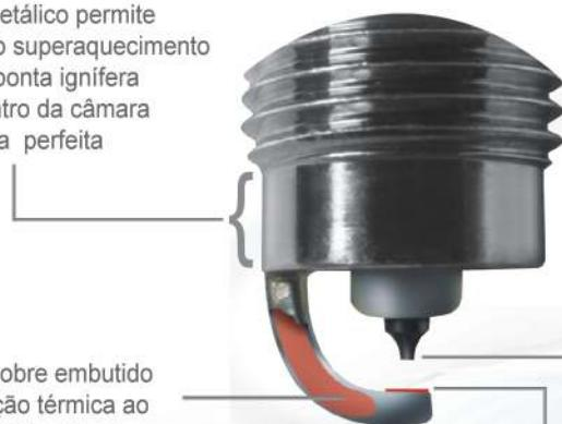
O eletrodo lateral com cobre embutido assegura maior dissipação térmica ao eletrodo evitando o derretimento do mesmo ao ser mais projetado para dentro da câmara de combustão
