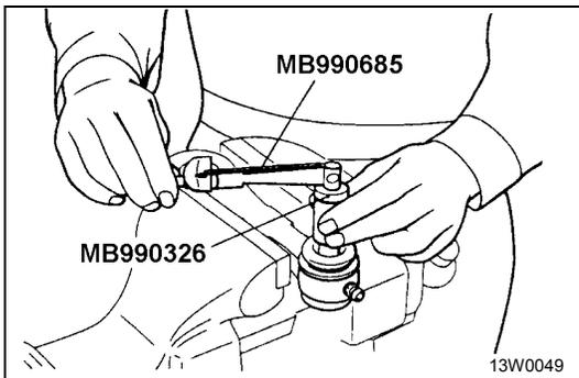
**PITMAN ARM BALL JOINT STARTING TORQUE**
