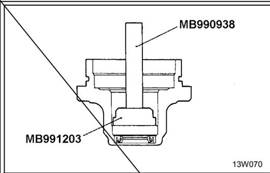
**5. INSTALLATION OF BEARING**
