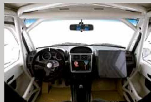
Novo design interno com painel do Pajero TR4 Flex, ar-condicionado, mesa de navegação de fibra de carbono e apoio de pé para piloto e navegador de kevlar. Muito mais conforto para a dupla.
