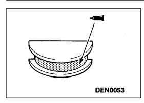
►J◀ SEALANT APPLICATION ON SEMI-CIRCULAR PACKING
