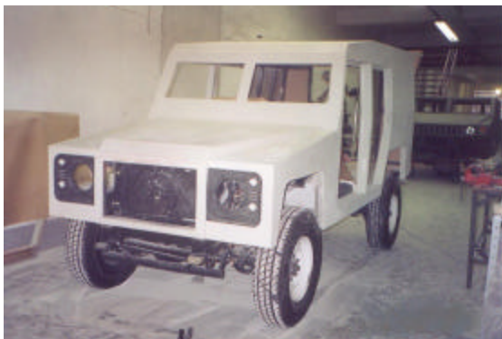
Detalhes da construção da carroceria blindada. (autor)
