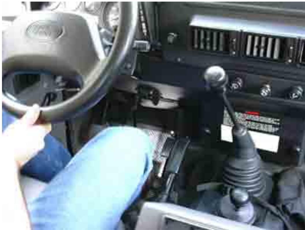
4. Sem pressionar a embreagem, desloque a alavanca do diferencial central para a esquerda, independentemente de estar reduzido ou em alta. A luz espia do painel deverá acender.
