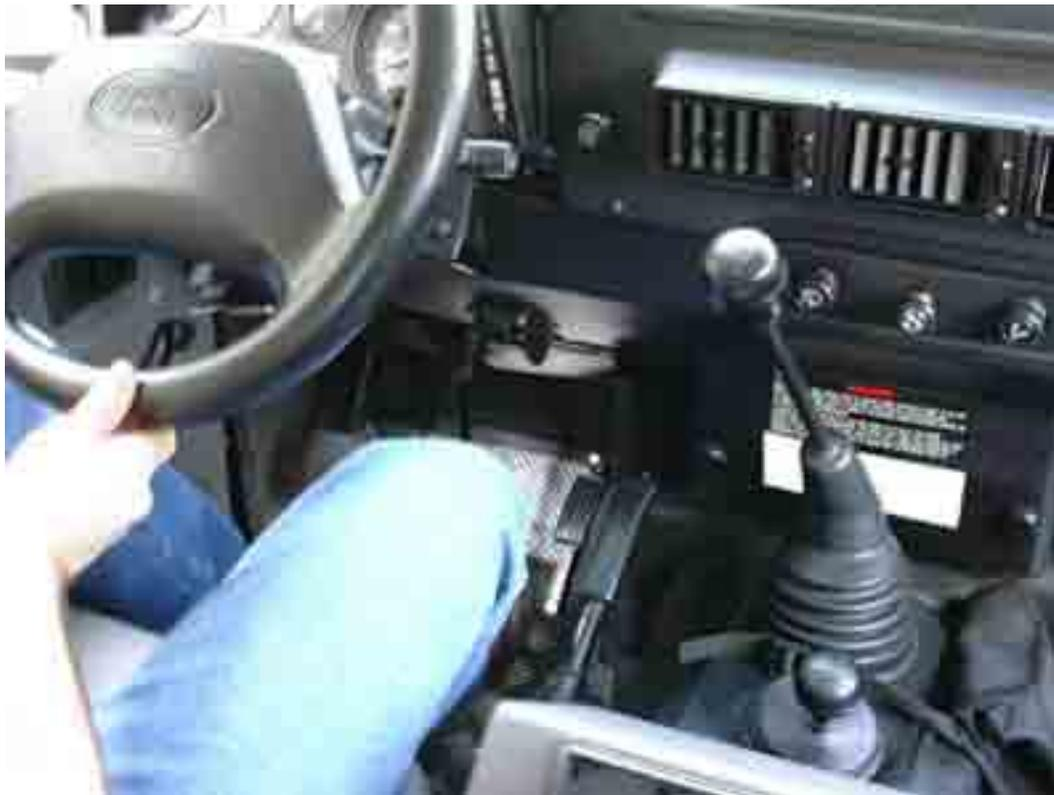
4. Sem pressionar a embreagem, desloque a alavanca do diferencial central para a direita, independentemente de estar reduzido ou em alta. A luz espia do painel deverá apagar em alguns segundos.
