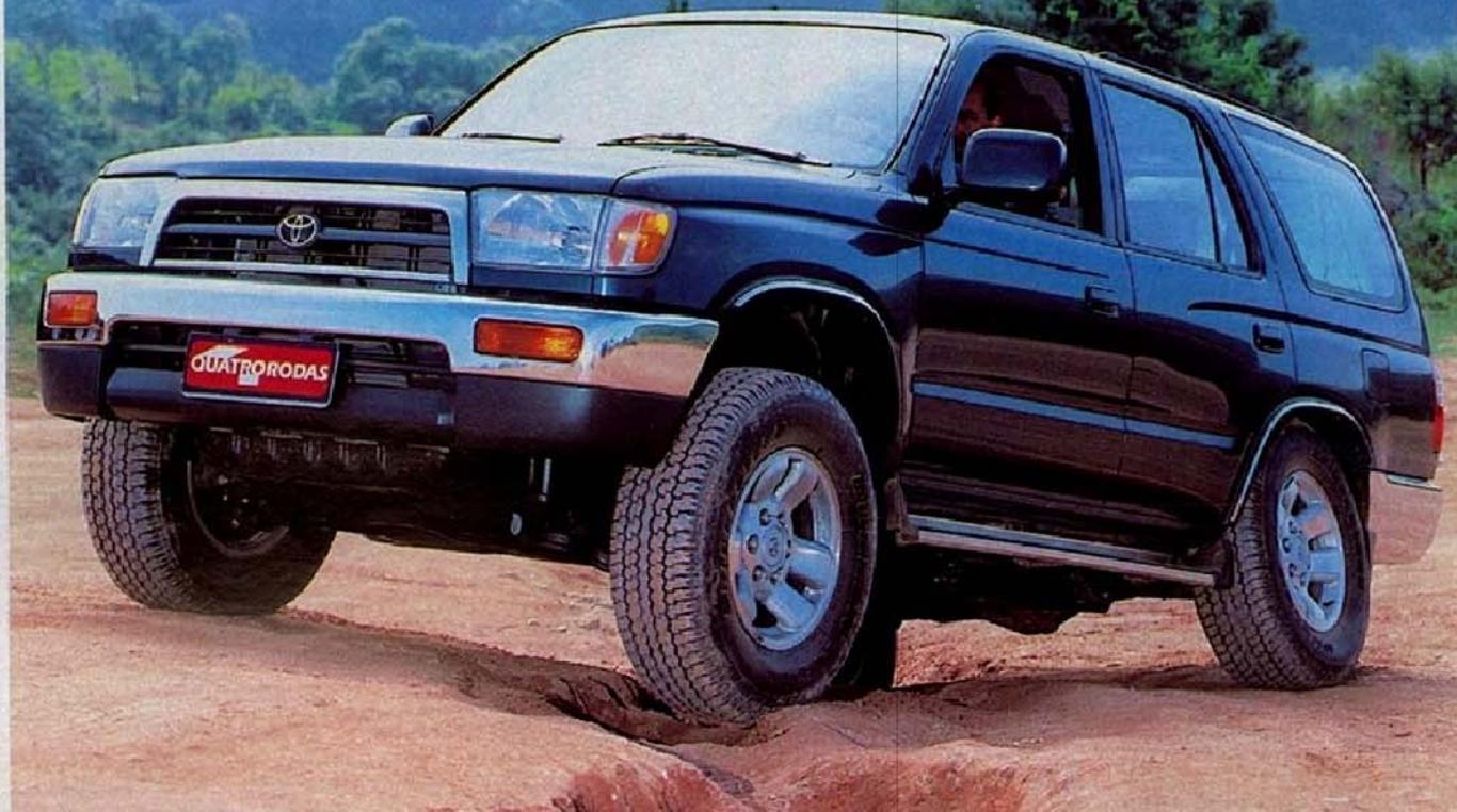
As suspensões do Toyota são as mais longas, o que evita que a carroceria torça ao vencer erosões como as da foto acima
