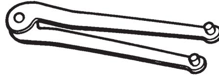
**Removedor/Instalador do Tampão da Direção C-4381**
