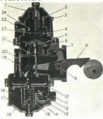
FIG. 13-FUEL AND VACUUM PUMP
