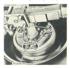
FIG. 28-BRAKE ADJUSTMENTS
