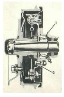
FIG. 32---REAR WHEEL HUB AND BEARING
