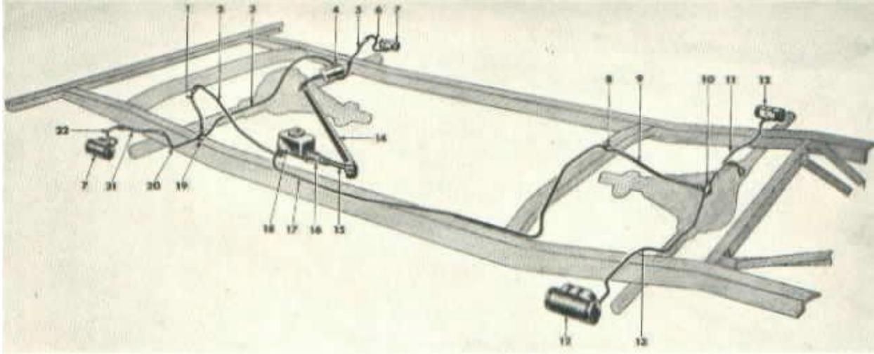
FIG. 29—HYDRAULIC BRAKE SYSTEM
