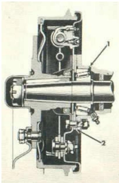
FIG. 32---REAR WHEEL HUB AND BEARING
