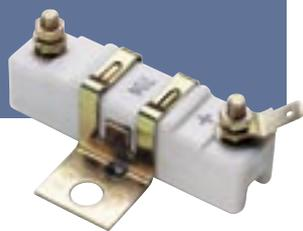
También conocido como “resistencia”, su finalidad es disminuir la tensión de alimentación en la bobina, disminuyendo la corriente. Con eso se evita la quema del platino y se protege la propia bobina.
