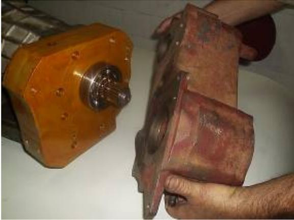
**ENCAIXE A REDUZIDA (NÃO ESQUEÇA DA JUNTA DA REDUZIDA)**
