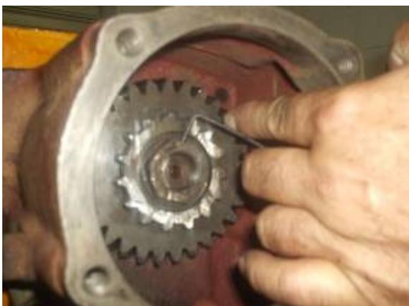
APÓS UM BOM APERTO NA PORCA DE FIXAÇÃO DA ENGRENAGEM DA REDUZIDA, APORTE O PARAFUSO ALLEN DA LATERAL DA PORCA PARA GARANTIR QUE A PORCA NÃO SOLTE
