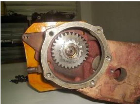
**ENGRENAGEM DA REDUZIDA ENCAIXADA**
