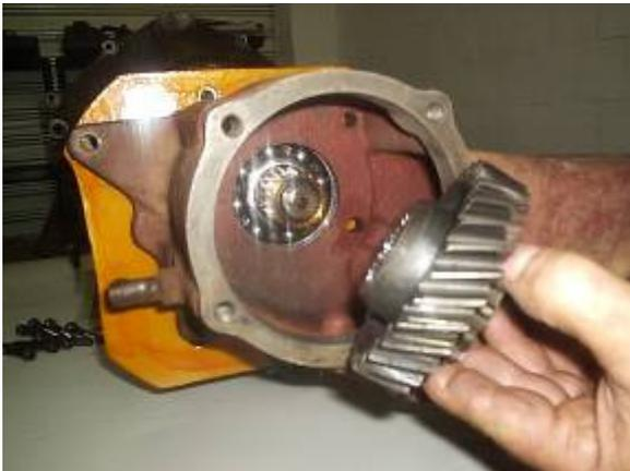
**COLOQUE A ENGRENAGEM DA REDUZIDA**
