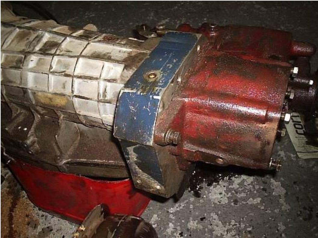
**COMPRIMENTO TOTAL DO CONJUNTO APÓS A MONTAGEM COMPLETA 770MM, DE PONTA A PONTA DO CÂMBIO A REDUZIDA**
