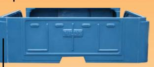
Acima traseira no modelo original para fixação das laternas externamente. Abaixo traseira com encaixes embutidos para lanternas redondas.
