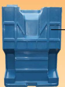
Parte inferior da carroceria, repare nas colunas de reforço aplicadas em todo assoalho
