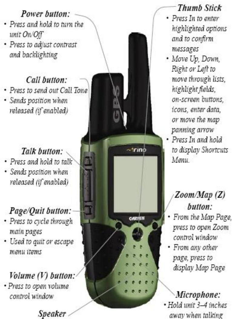
**Botão de Energia (Power Button):** Pressione e segure para ligar/desligar a unidade; Pressione para ajustar o contraste e a luz de fundo.
