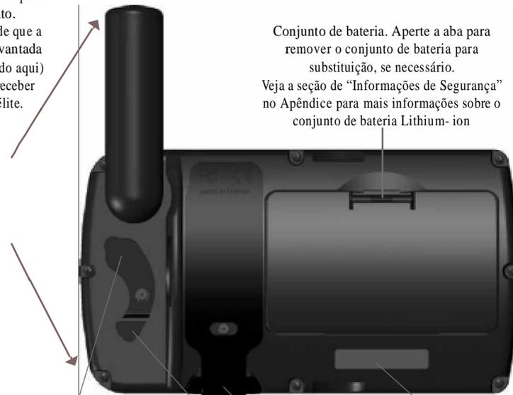
Conjunto de bateria. Aperte a aba para remover o conjunto de bateria para substituição, se necessário. Veja a seção de “Informações de Segurança” no Apêndice para mais informações sobre o conjunto de bateria Lithium- ion
