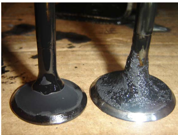
Figura 24. Depósito na válvula de admissão no tratamento OV0/Tamb
