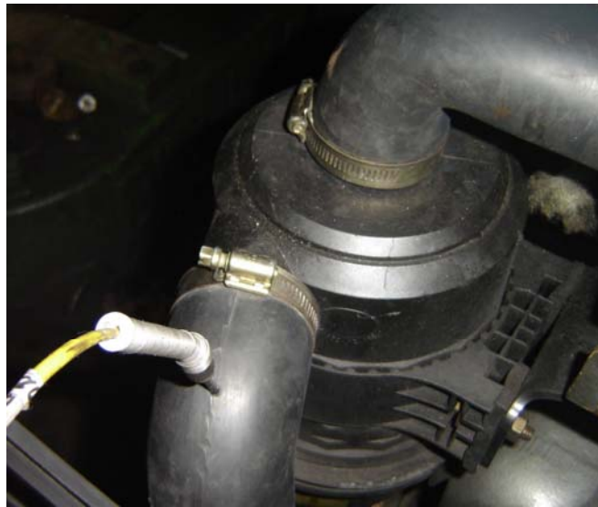
Figura 5. Termopar instalado para medição da temperatura dos gases de admissão.
