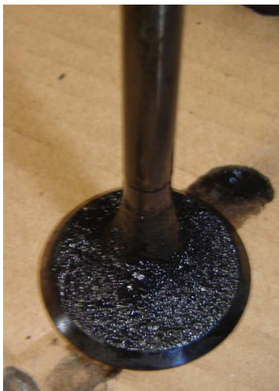
Figura 21. Deposição de resíduos na válvula de admissão no tratamento OV5/Tamb.
