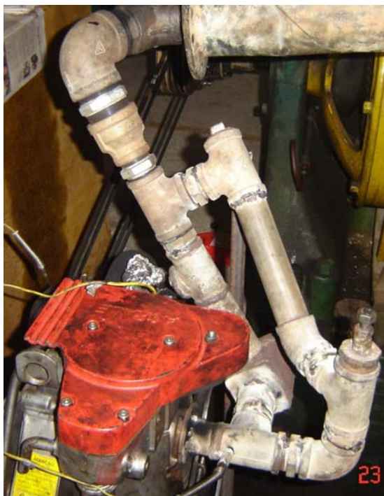
Figura 3. Sistema de aquecimento de combustível desenvolvido para motor estacionário Agrale, modelo M90.
