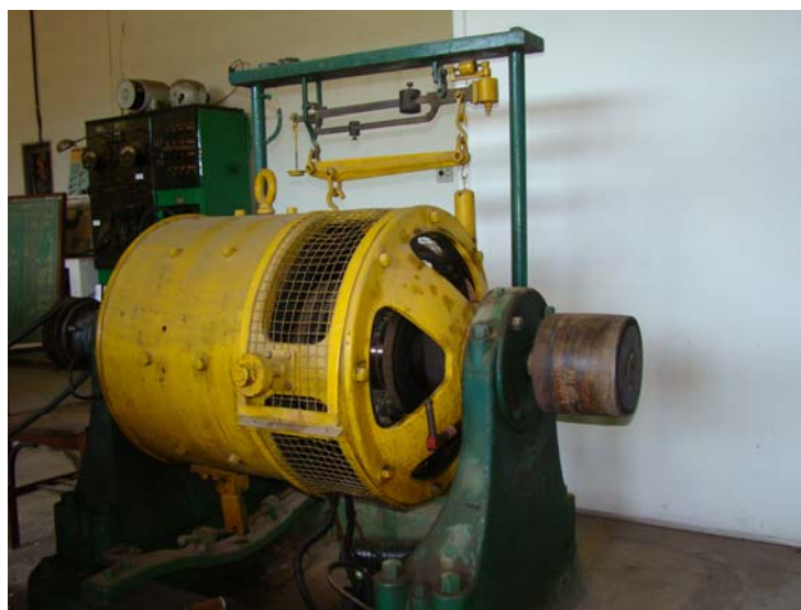
Figura 1. Dinamômetro utilizado na avaliação do motor.
