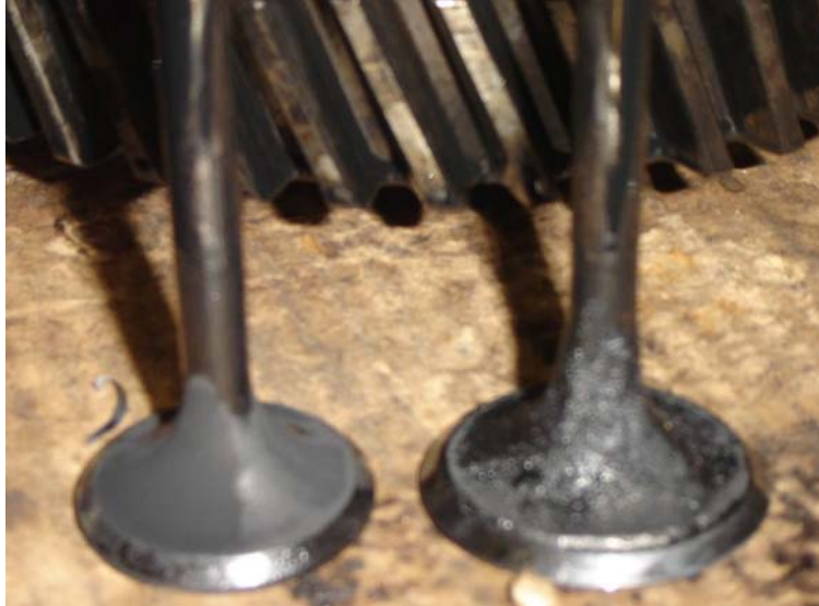
Figura 26. Deposição de resíduos na válvula de admissão no tratamento OV50/T90
