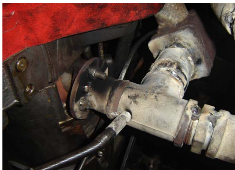
Figura 7. Termopar instalado para medição das temperaturas dos gases de escape.
