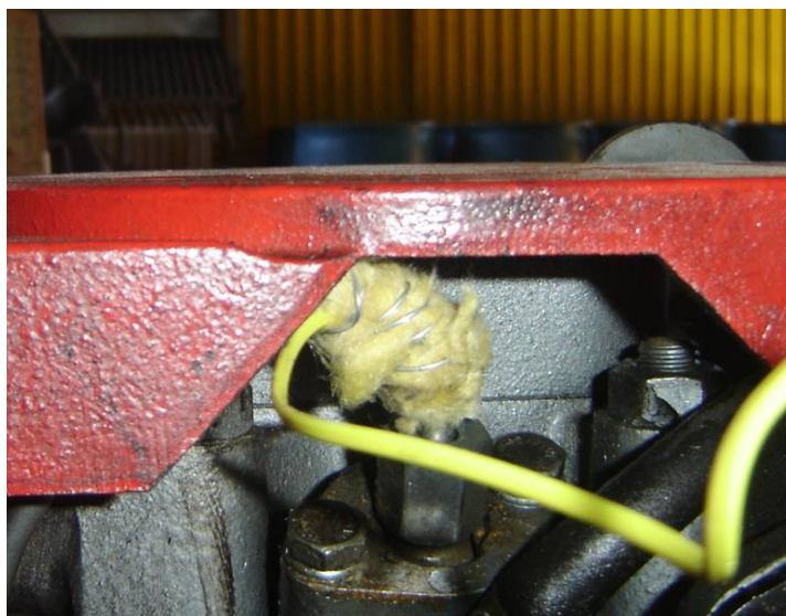
Figura 5. Termopar utilizado para coleta da temperatura de injeção, coberto com isolante térmico.
