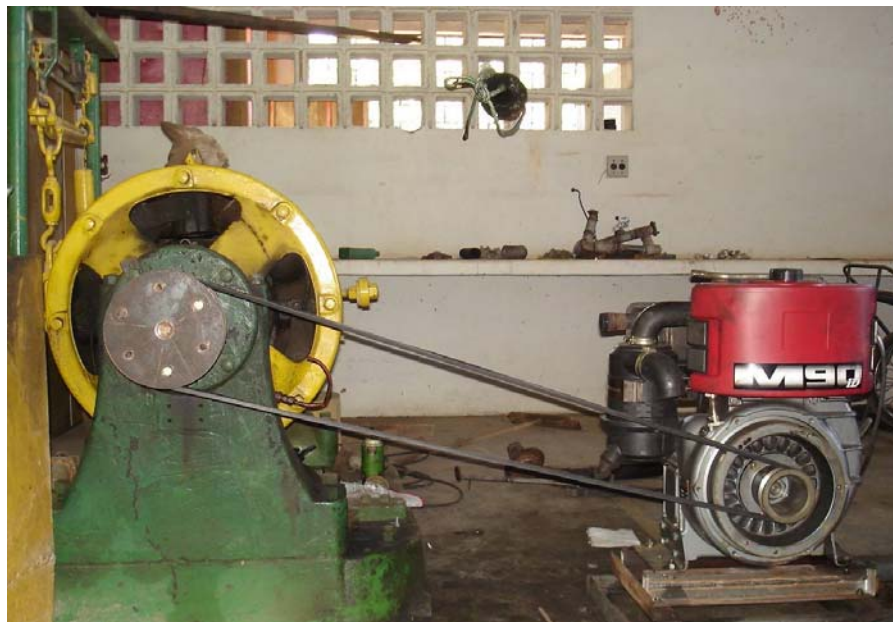
Figura 1. Motor acoplado ao dinamômetro, para realização dos ensaios de desempenho do motor.
