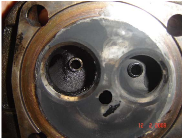
Figura 25. Depósito no cabeçote no tratamento OV0/Tamb.
