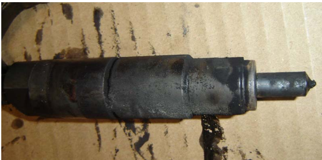
Figura 23. Deposição de resíduos no bico injetor no tratamento OV05/Tamb.
