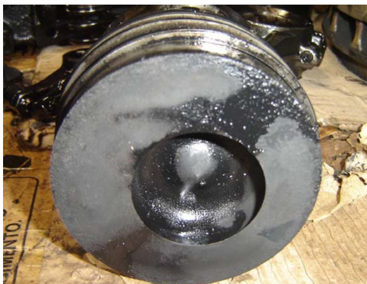
Figura 28. Situação do pistão no tratamento OV50/T90.
