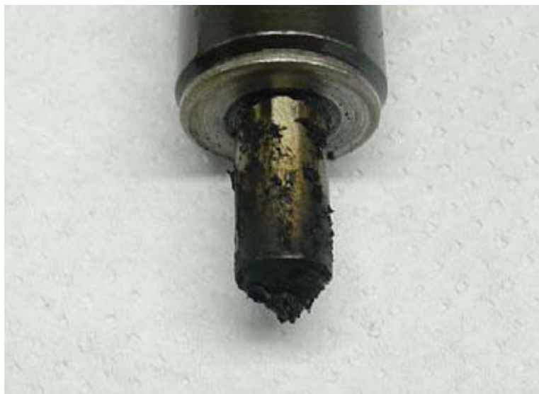
Figura 1. Carbonização do bico injetor relatado por Mazieiro e Corrêa (2004).
