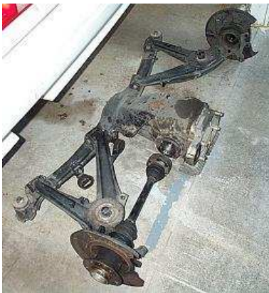
Ao lado: Braços da “semi-trailing arm” da BMW E30
