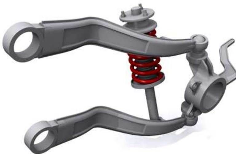
Arranjo para suspensão dianteira tipo “trailing arm”.
