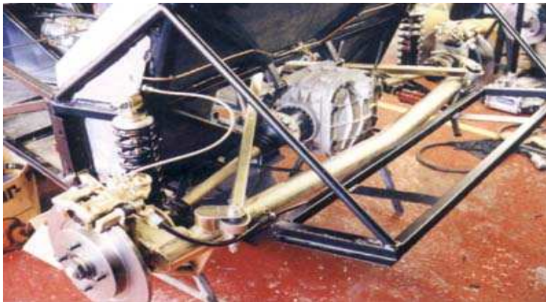
Abaixo : Eixo De Dion com discos de freio montados no cubos de rodas
