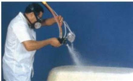
Estamos prontos para laminar as camadas estruturais da banheira. Primeiro é aplicada uma demão de resina, sem fibras de vidro. Essa resina serve para impregnar as fibras de baixo para cima e assim facilitar a remoção das bolhas de ar. Em seguida é laminada a primeira camada estrutural com resinas e fibras. O poliéster impregna com rapidez as fibras, impedindo que elas caiam mesmo quando aplicadas em paredes verticais.
