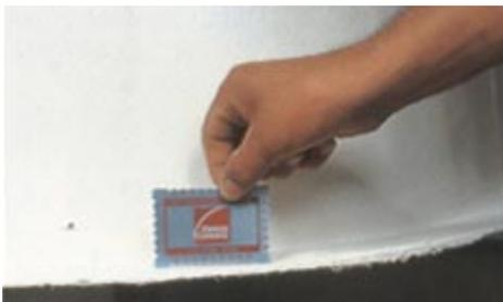
A espessura é conferida com o gelcoat ainda líquido, antes da gelatinização, e deve ficar em torno de 0,5 mm. Se o gelcoat tiver espessura muito pequena, inferior a 0,3 mm, ele corre o risco de enrugar ao ter contato com o estireno da resina do laminado estrutural. Por outro lado, se a espessura for maior que 0,5 mm, a peça fica muito suscetível a empenamento e a trincas superficiais.
