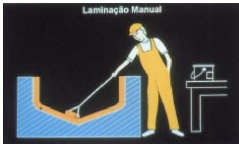
Podemos agora iniciar a descrição dos processos, começando com a laminação manual de uma caixa d'água usando molde de Fiberglass.
