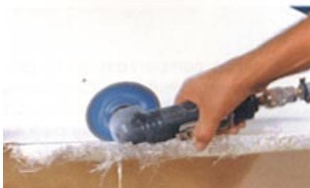
O acerto final das bordas é feito com lixadeira e eventuais cortes ou furos são feitos com ferramentas diamantadas. Se desejado, o brilho superficial pode ser acentuado polindo a peça com massa usada para polir automóveis.
