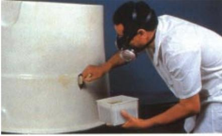
A laminação da primeira camada estrutural é iniciada banhando a superfície do molde (coberta por gelcoat) com resina devidamente catalisada e acelerada. Isso pode ser feito com pincel ou com rolo de lã. A manta de fibras de vidro deve ser aplicada antes da gelatinização dessa camada de resina. A manta é previamente cortada com faca ou tesoura antes de ser colocada no molde.
