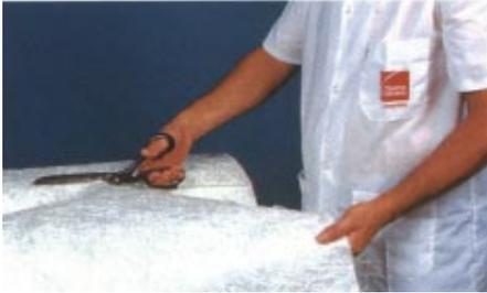
Aqui vemos a manta sendo posicionada sobre o molde. A laminação prossegue aplicando o poliéster com pincéis ou com rolos de lã. O laminado deve ser compactado com roletes para impregnar as fibras e eliminar as bolhas de ar. A espessura final da peça é obtida aplicando várias camadas ou lâminas de manta. E por isso que as estruturas de Fiberglass são conhecidas como "laminados" e sua moldagem é chamada de "laminação".
