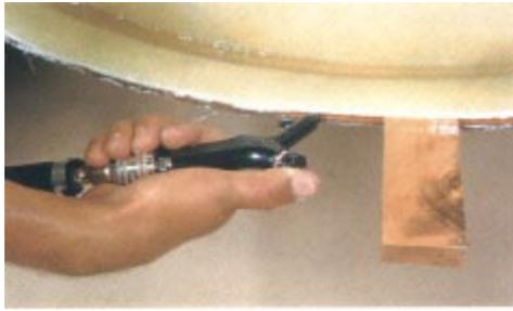
A desmoldagem é feita inserindo cunhas de madeira entre o molde e a peça. Algumas peças mais complicadas só saem do molde com aplicação de ar comprimido. As estruturas de Fiberglass são leves e fáceis de ser manuseadas. Podemos notar que a superfície interna da caixa d'água reproduz com precisão os detalhes do molde. A caixa moldada com gelcoat sai do molde acabada e na cor desejada, sem necessitar pintura.
