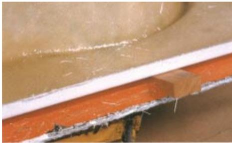
A cura segue seu curso normal e a peça pode ser desmoldada quando esfriar. A desmoldagem é feita com cunhas de madeira ou com ar comprimido, do mesmo modo que no processo manual. As peças feitas em Fiberglass são leves e fáceis de ser desmoldadas
