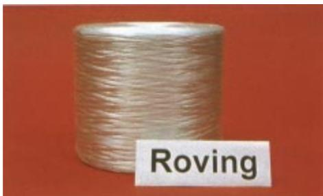
A laminação a pistola é feita com fibras contínuas conhecidas como roving. As fibras do roving devem ser cortadas antes de ser impregnadas com resina poliéster. O roving tem custo mais baixo que as mantas e os tecidos e por isso são muito usados nos processos de laminação com moldes abertos.
