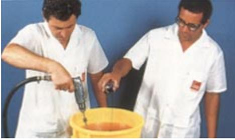
Vamos mostrar a aplicação do laminado estrutural. Da mesma maneira que o gelcoat, a resina de laminação também deve ser ativada com cobalto e com MEKP. Primeiro o cobalto é adicionado em uma quantidade grande de resina.
