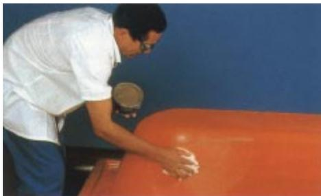
Vamos moldar uma banheira para ilustrar o processo de laminação a pistola. Primeiro o molde deve ser encerado com várias demãos de cera desmoldante. As várias demãos de cera que devem ser polidas antes da evaporação dos solventes. A superfície do molde deve estar bem polida e brilhante para transferir essas qualidades à peça moldada.
