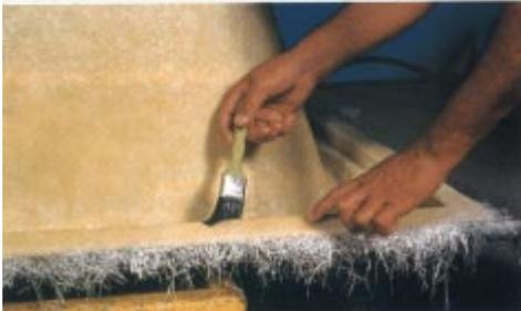
A uniformidade da espessura depende da habilidade do operador. Se for seguida a recomendação para aplicar 1,5 mm por camada, um laminado de 3,3 mm de espessura requer duas aplicações da pistola de laminação e uma aplicação da gelcoateadeira.
