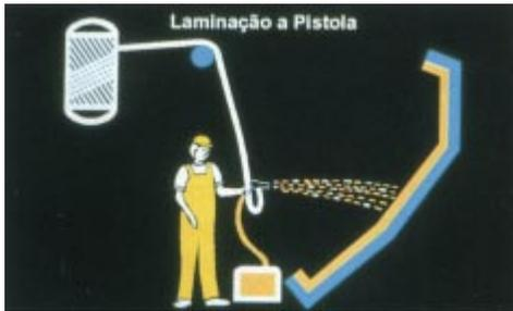
Vamos ver como é feita a laminação à pistola. Nesse processo as fibras de vidro, a resina e o gelcoat são aplicados com máquinas pneumáticas especialmente construídas para essa finalidade.
