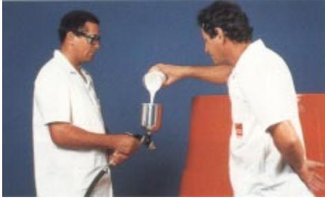
No processo manual o gelcoat é aplicado com pistolas de caneco, do mesmo tipo das usadas para aplicar tintas em pintura convencional. Essas pistolas devem ter o bico grande para facilitar a aplicação de materiais de alta viscosidade como os gelcoats. Algumas vezes o gelcoat é aplicado sem pistola, com pincéis ou rolos de pintor. Isso pode ser feito, mas em nossa opinião melhores resultados são obtidos com o uso de pistolas.
