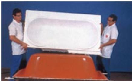
superfície lisa da banheira, feita em gelcoat, reproduz com fidelidade os detalhes do molde. Observe que a borda inferior direita não foi rebarbada no molde, antes da cura completa da resina. Quando isso acontecer, a rebarbação deve ser completada com disco de corte, porque um laminado curado não pode ser cortado com faca ou com espátula.
