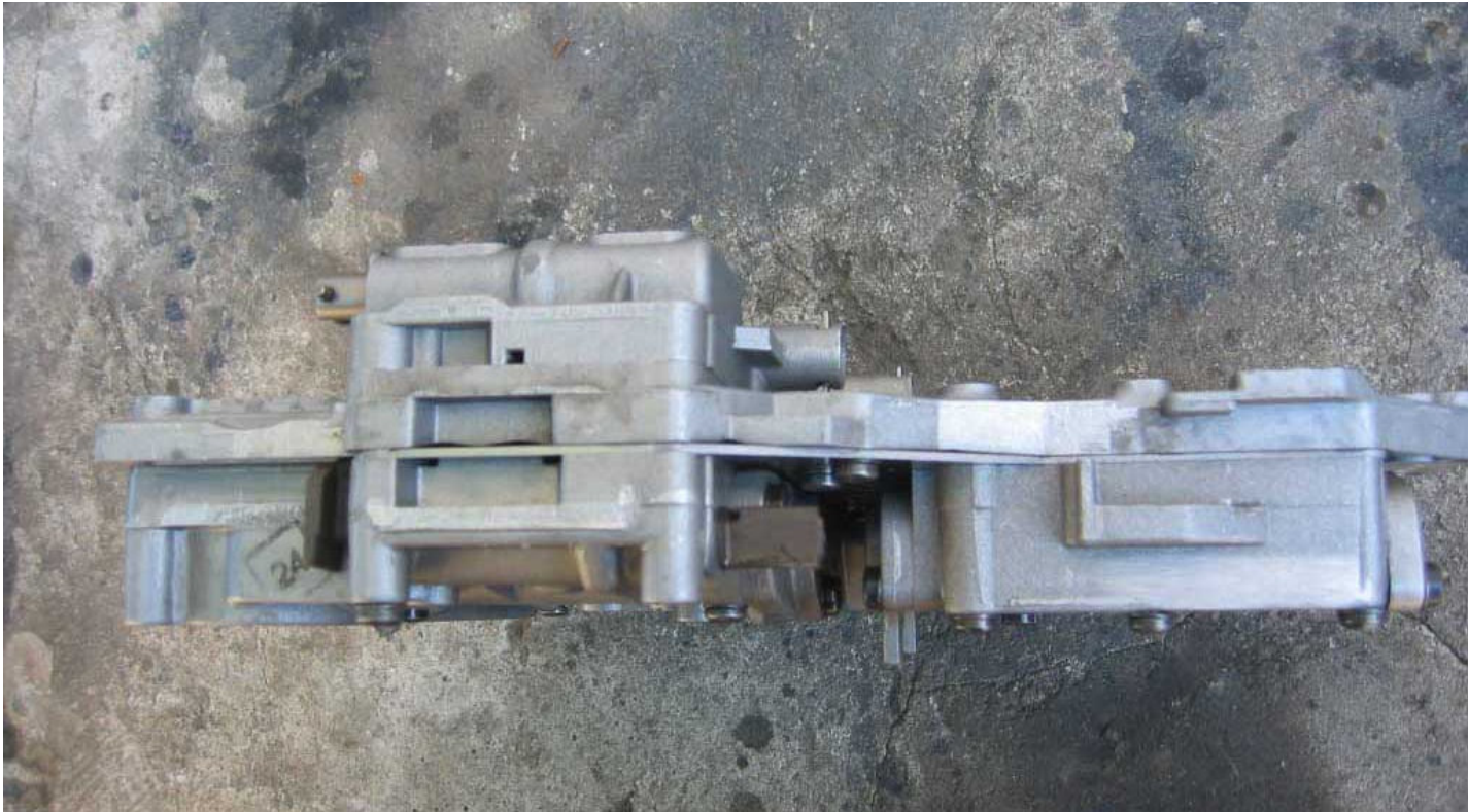
O corpo de válvulas visto de lado. Note a chapa de aço intermediária que fica entre os subconjuntos.
