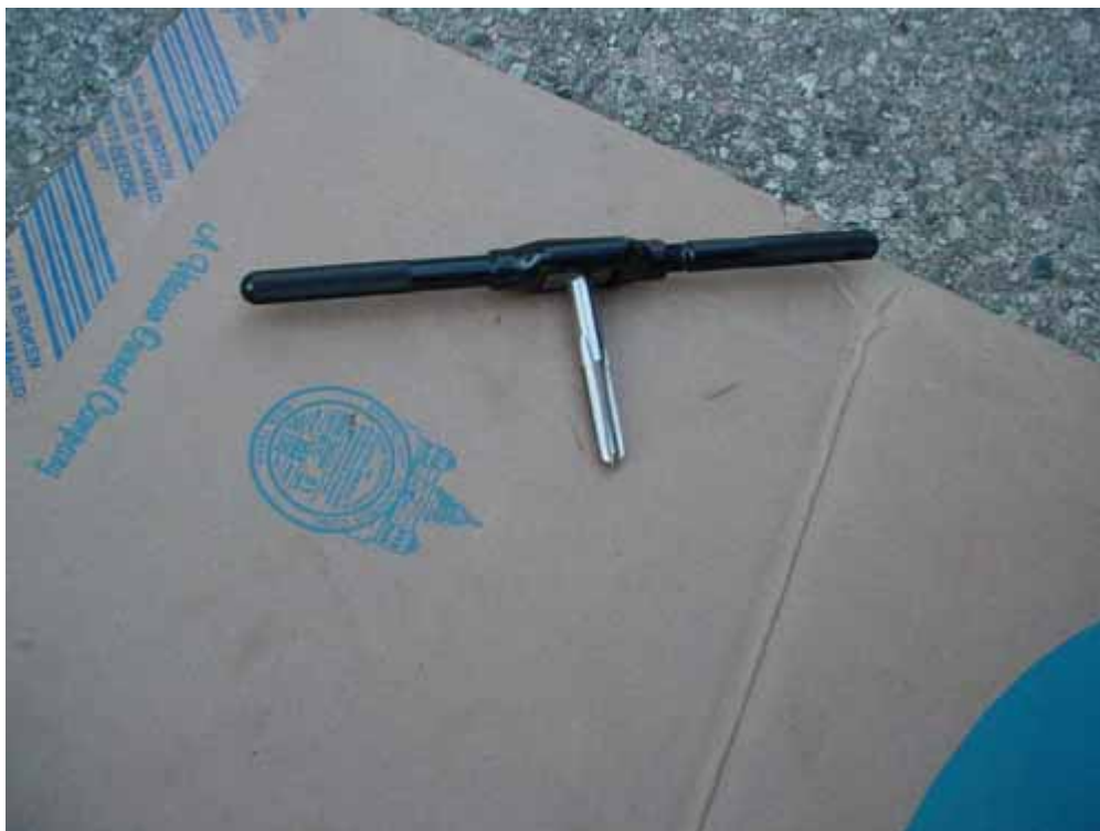
Macho para fazer a rosca no furo central do eixo
