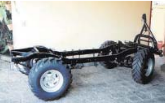
O chassi original do jipe clássico ganhou um grande reforço com o trabalho artesanal feito pelo próprio dono
