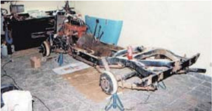
O chassi original do jipe clássico ganhou um grande reforço com o trabalho artesanal feito pelo próprio dono
