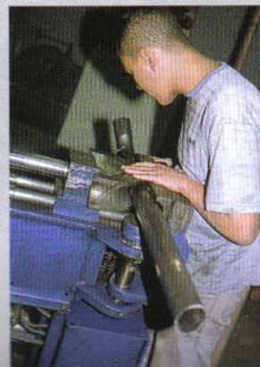
Máquina faz dobras no cano
