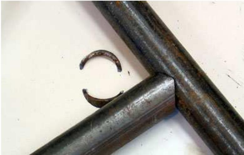
Fig 8 – Teste de encaixe do corte
