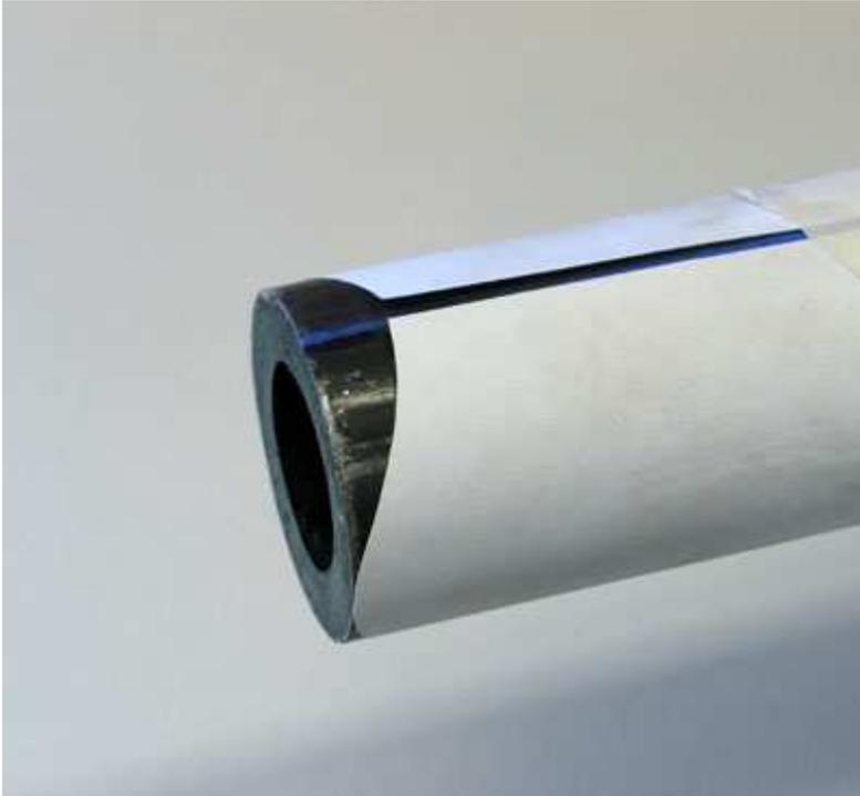
Fig 10 – Padrão gerado pelo Winmiter e colado com fita adesiva sobre o tubo.
