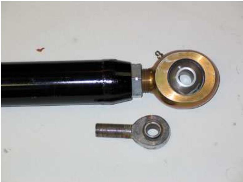
Figure 15 – Link completo com Evolution Joint mostrado proximo á um padrão de 3/4" Heim joint para uma visão em escala.
