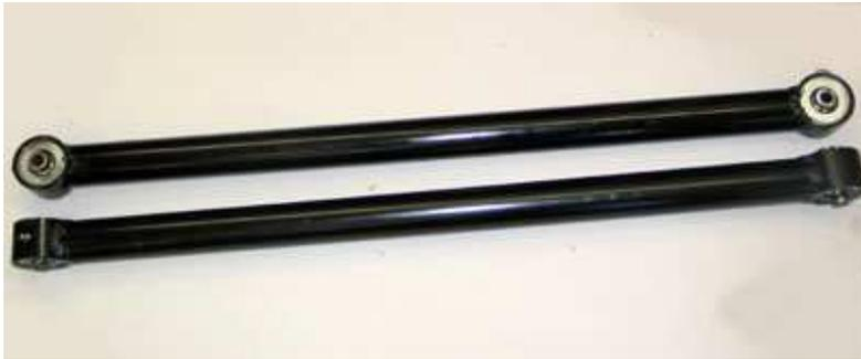
Figure 14 – Links frontais de comprimento fixo usando RE bearings com 2" x 3/8" DOM
