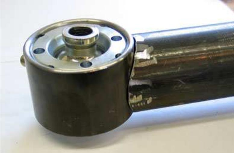
Figure 11 – Tubo de 2” perfeitamente encaixado.
