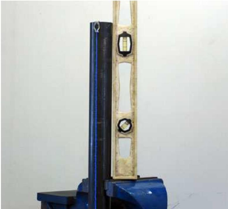
Figure 1 – Usando um medidor de nível para marcar a linha de centro do tubo.
