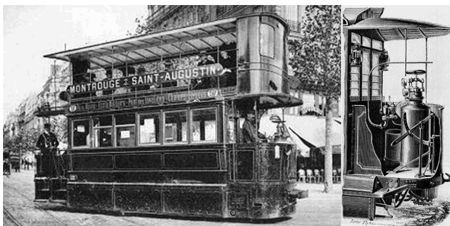
Figura 7 – Em Paris, circa 1900, bonde a ar comprimido, com tanque no detalhe. (Tramway Information, 2008).
