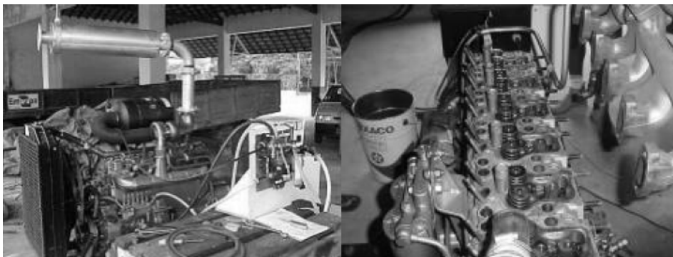
Figura 31 – Grupo gerador na Embrapa e desmontagem do motor (Coelho, 2004).
