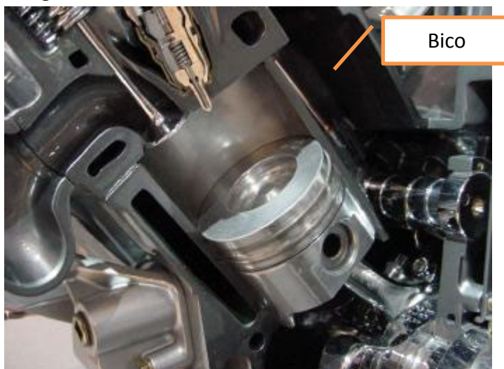
Figura 30. Localização do bico injetor no cabeçote do motor.
