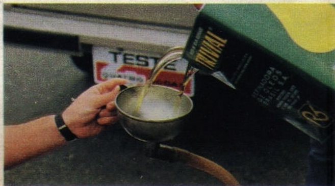
Óleo de soja: com a mesma injeção do diesel.
