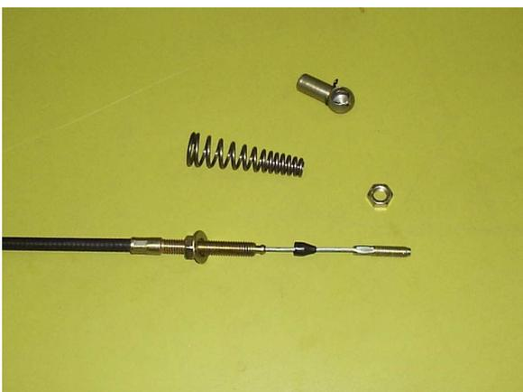
**RETIRE O TERMINAL ESFÉRICO, A MOLA, AFASTE O RETENTOR E RETIRE A PORCA**
