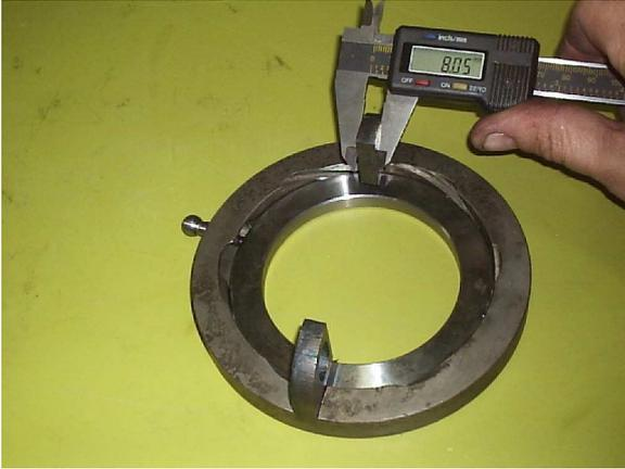
**FAÇA A MEDIÇÃO DA ESPESSURA DAS ALHETAS DE FIXAÇÃO DO ANEL DE ENGATE UTILIZANDO UM PAQUÍMETRO DIGITAL**
