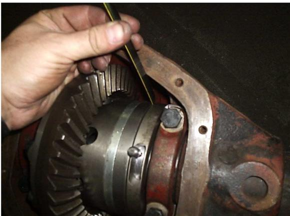
**CONFIRME QUE DEVE PERMANECER UM ESPAÇAMENTO MÁXIMO DE 0,50MM ENTRE A LUVA DE ENGATE E A CAIXA DE SATÉLITES APÓS O APERTO DEFINITIVO DOS PARAFUSOS DO MANCAL**
