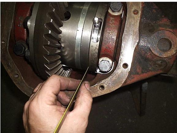
**REGULE COM O CÁLIBRE DE LÂMINAS UM ESPAÇAMENTO DE 0,20 A 0,50MM ENTRE A LUVIA DE ENGATE E A CAIXA DE SATÉLITES (FAÇA ESTA OPERAÇÃO EM CIMA E EMBaixo DA CAIXA), E APERTE OS PARAFUSOS DOS MANCAIS**
