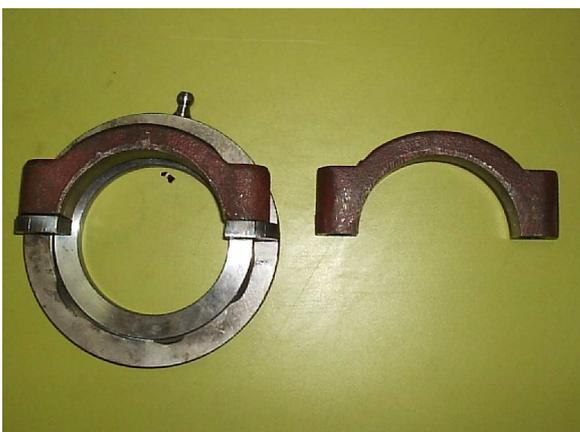
**ESTA DIFERENÇA DE ALTURA É PARA COMPENSAR A ESPESSURA DAS ALHETAS DE FIXAÇÃO DO ANEL DE ENGATE DO BLOQUEIO, QUE SÃO FIXADAS SOB O MANCAL DIREITO**
