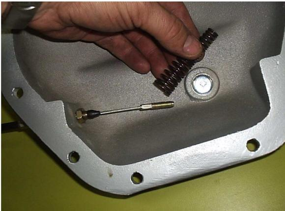
**COLOQUE A MOLA CÔNICA, COM O DIÂMETRO MENOR PARA PONTA DO CABO**
