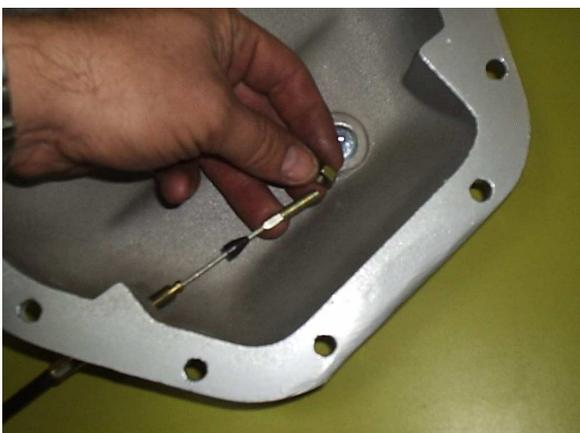
**COLOQUE A PORCA DE FIXAÇÃO DO CABO**
