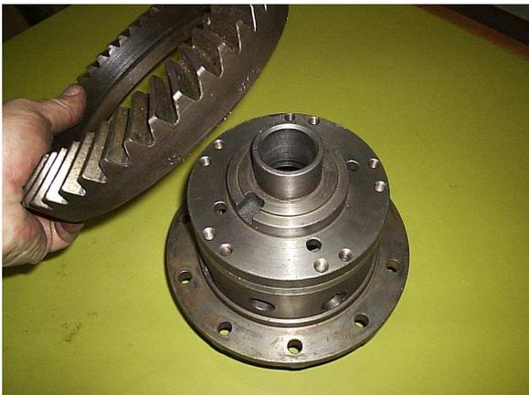
**COLOQUE A COROA RETIRADA DA CAIXA ORIGINAL NA CAIXA DO BLOQUEIO**
