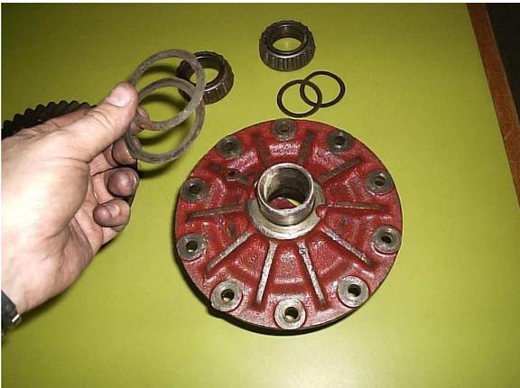
**RETIRE OS CALÇOS DE AJUSTE SOBRE O ROLAMENTO ESQUERDO (NÃO OS MISTURE COM OS CALÇOS DO LADO DIREITO), SE HOUVEREM**
