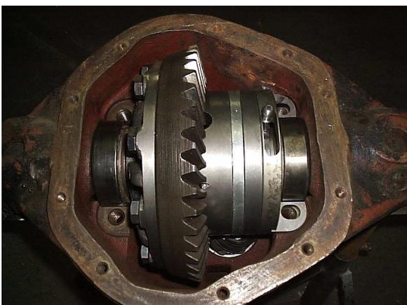
**COLOQUE A CAIXA MONTADA NO LOCAL PARA VERIFICAR O PERFEITO AJUSTE DO CONTATO DOS DENTES DA COROA E PINHÃO, CASO NECESSÁRIO REFAÇA A REGULAGEM DA COROA E PINHÃO – PÁGINA 28**
