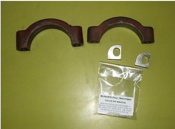
**MEDIANTE SOLICITAÇÃO, É FORNECIDO UM JOGO DE CALÇOS CALIBRADOS PARA SEREM MONTADO SOB O MANCAL DIREITO FAZENDO A COMPENSAÇÃO DA ESPESSURA FRESADA, PARA RETORNO DA CAIXA DE SATÉLITES ORIGINAL NO CASO DE RETIRADA DO BLOQUEIO**
