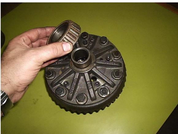
**PARA FACILITAR A MOVIMENTAÇÃO DOS CALÇOS SOB OS ROLAMENTOS PARA A CORRETA REGULAGEM DO CONTATO COROA/PINHÃO OS ROLAMENTOS NÃO SÃO MONTADOS COM MUITA PRESSÃO. APÓS A REGULAGEM DA COROA, COM A DEFINIÇÃO DOS CALÇOS DEFINITIVOS MONTAR OS ROLAMENTOS COM TRAVA QUÍMICA DE ALTO TORQUE (COLA VERMELHA)**
