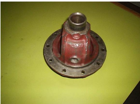
**A CAIXA DE SATÉLITES ORIGINAL, NÃO SERÁ UTILIZADA (PODE SER GUARDADA PARA SUBSTITUIÇÃO DO BLOQUEIO EM CASO DE VENDA DO VEÍCULO)**
