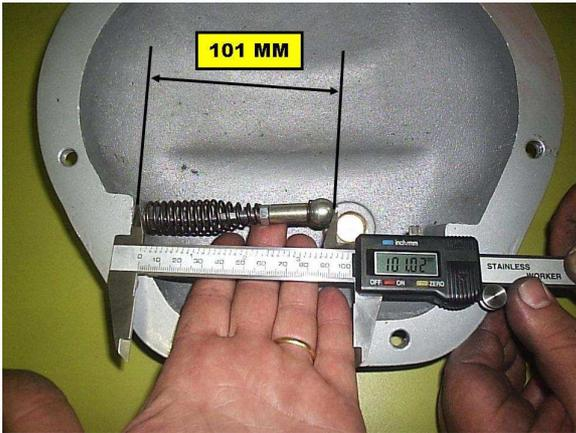
ROSQUEIE O TERMINAL ESFÉRICO SOBRE A CONTRA PORCA REGULANDO O COMPRIMENTO TOTAL EM 101MM, COM A ALAVANCA NA POSIÇÃO DESBLOQUEADO E APERTE A CONTRA PORCA.
