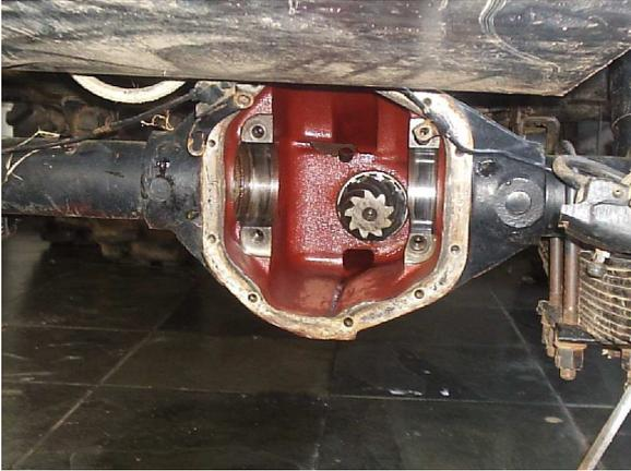
**RETIRE A CAIXA DE SATÉLITES ORIGINAL E LIMPE BEM O INTERIOR DA CARÇAÇA, ESPECIALMENTE OS PONTOS DE CONTATO DOS ROLAMENTOS E DOS MANCAIS**
