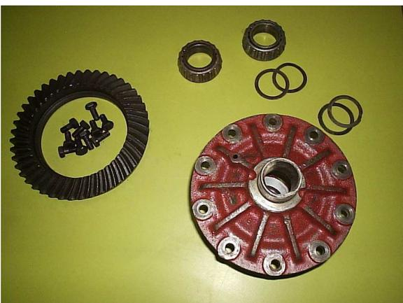
**PEÇAS DA CAIXA ORIGINAL QUE SERÃO UTILIZADOS NA CAIXA DO BLOQUEIO, COM EXCEÇÃO DA CAIXA DE SATÉLITES ORIGINAL (NOTE OS CALÇOS SOBRE OS ROLAMENTOS SEPARADOS POR LADO)**
