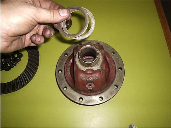
**RETIRE OS CALÇOS DE AJUSTE SOBRE O ROLAMENTO DIREITO (NÃO OS MISTURE COM OS CALÇOS DO LADO ESQUERDO), SE HOUVEREM**
