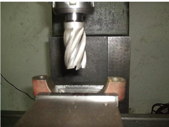
**FRESE A BASE DO MANCAL DIREITO REBAIXANDO NA MESMA ESPESSURA DAS ALHETAS DE FIXAÇÃO DO ANEL DE ENGATE (APROXIMADAMENTE 8 MM), CONFIRMAR COM O PAQUIMETRO DIGITAL**
